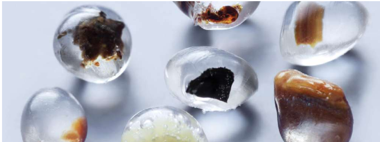
תמונה 1: פגמים נפוצים בחומרי גלם שניתן לזהות עם המערכת החדשה של OCS.
