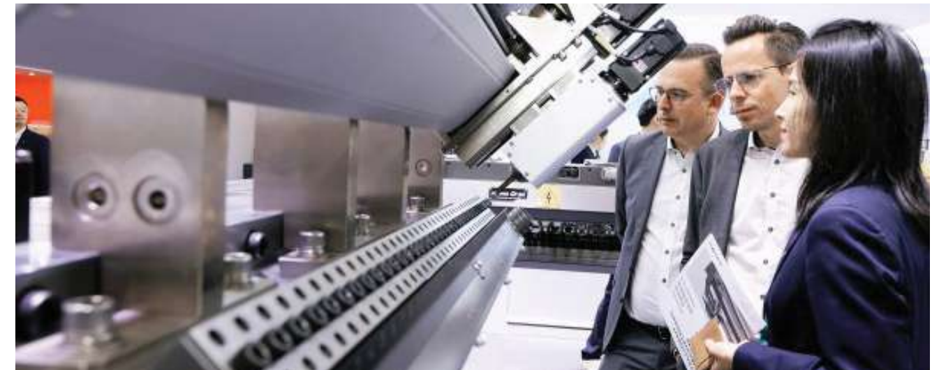
תמונה 1: המערכת החדשה, Intelligent Manufacturing, לשליטה אוטומטית על עובי הלוח ומפתח הדיזה.
