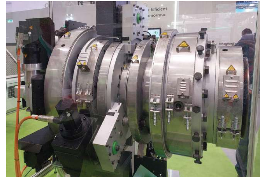
תמונה 1: דיזת Helix II עם שינוי קוטר צינור אוטומטי, ובקרת עובי דופן Online בביתן תערוכת ה-K.
