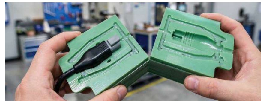
תמונה 2: תבניות הזרקה שהודפסו במדפסות Stratasys ליישומי אלקטרוניקה.
