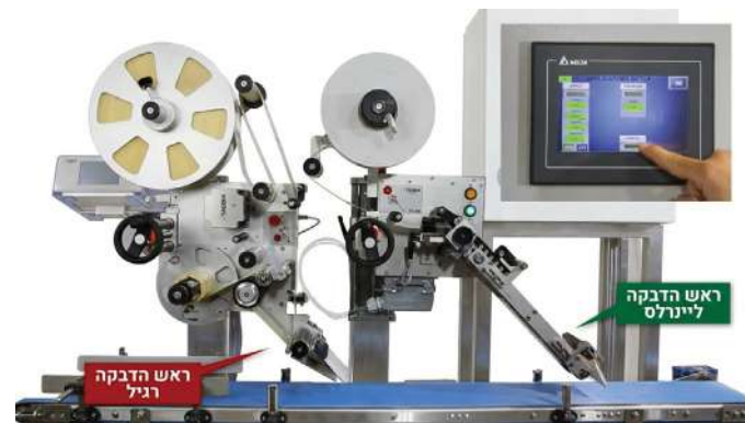
תמונה 1: מכונת הדבקה לינארית ליישום רציף של מדבקות רגילות Linerless.
