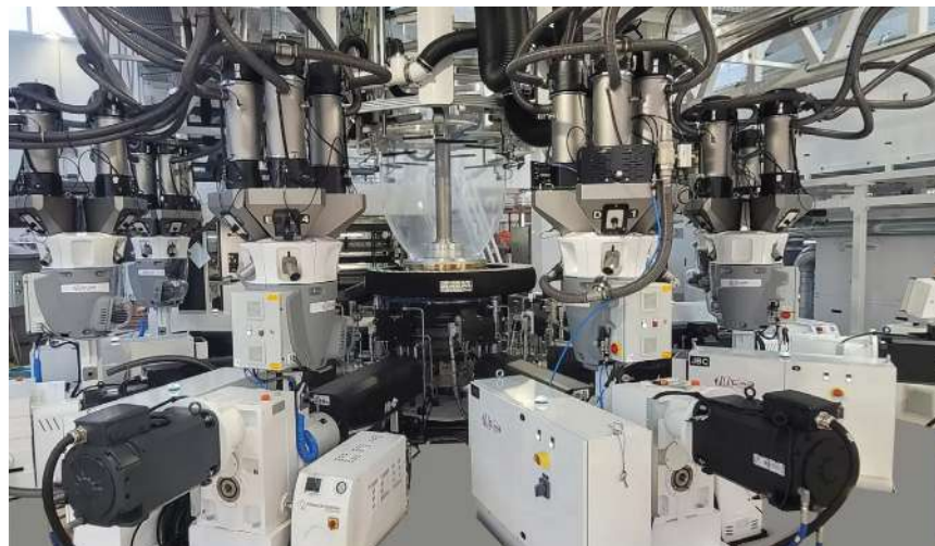
תמונה 1: קו האקסטרודיזיה הרב שכבתי החדש של Macchi ליריעות חסמות מתמחרות.
