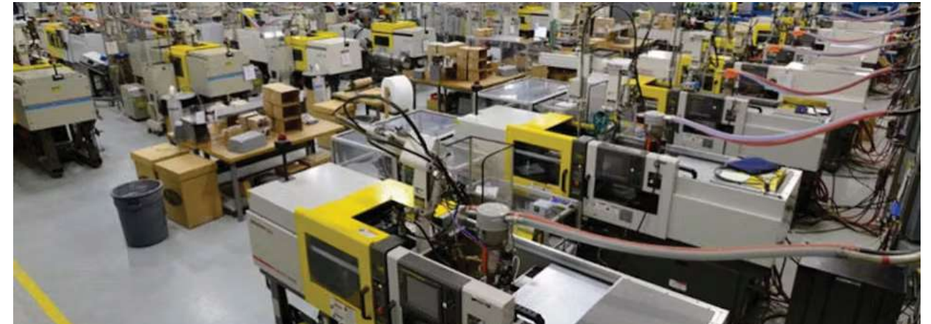
תמונה 1: אולם הייצור של חברת ABA-PGT המכיל 48 מכונות הזרקה ROBOSHOT של Fanuc.
