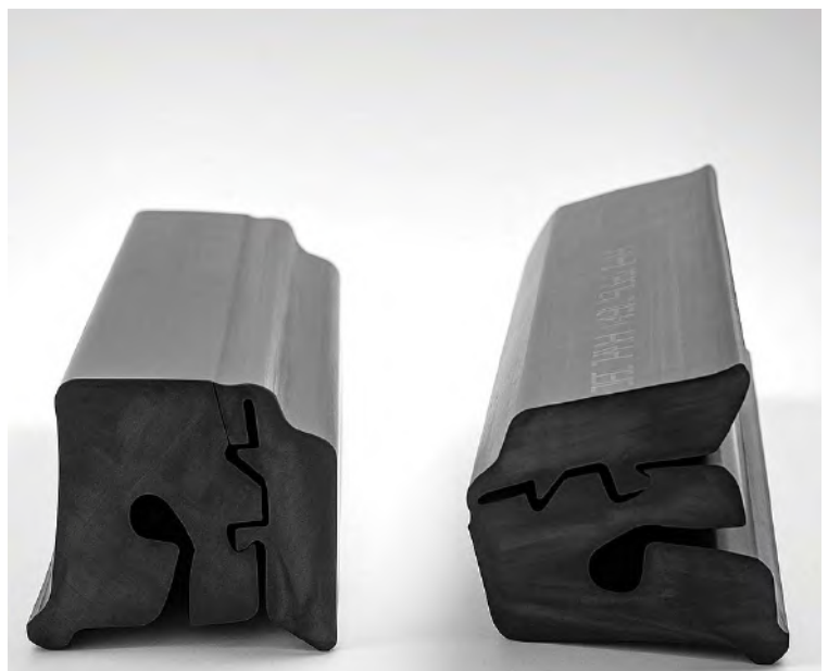
תמונה 1: האטמים שייצרה חברת סופרגום מהתערובת האוניברסלית העומדת בכל התקינה העולמית למי שתייה.
