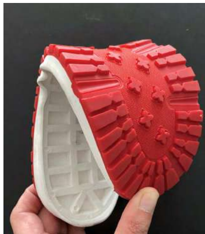
תמונה 3: סולית נעל מבוססת על SEBS, בקשיות של Shore A 70.
