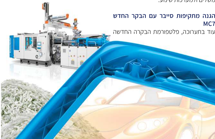
תמונה 1: תהליך לתירכוּב סיבי זכוכית ישירות על גבי מכונת ההזרקה יוצג בתערוכת הקרובה.
