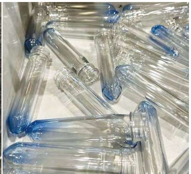
תמונה 1: מימין: מבחנות PET שהוזרקו מיד לאחר תהליך ה-Purge. משמאל: מבחנות לאחר 5 דקות של ייצור - תוך זמן קצר המבחנות שקופות ונקיות מצבע.
