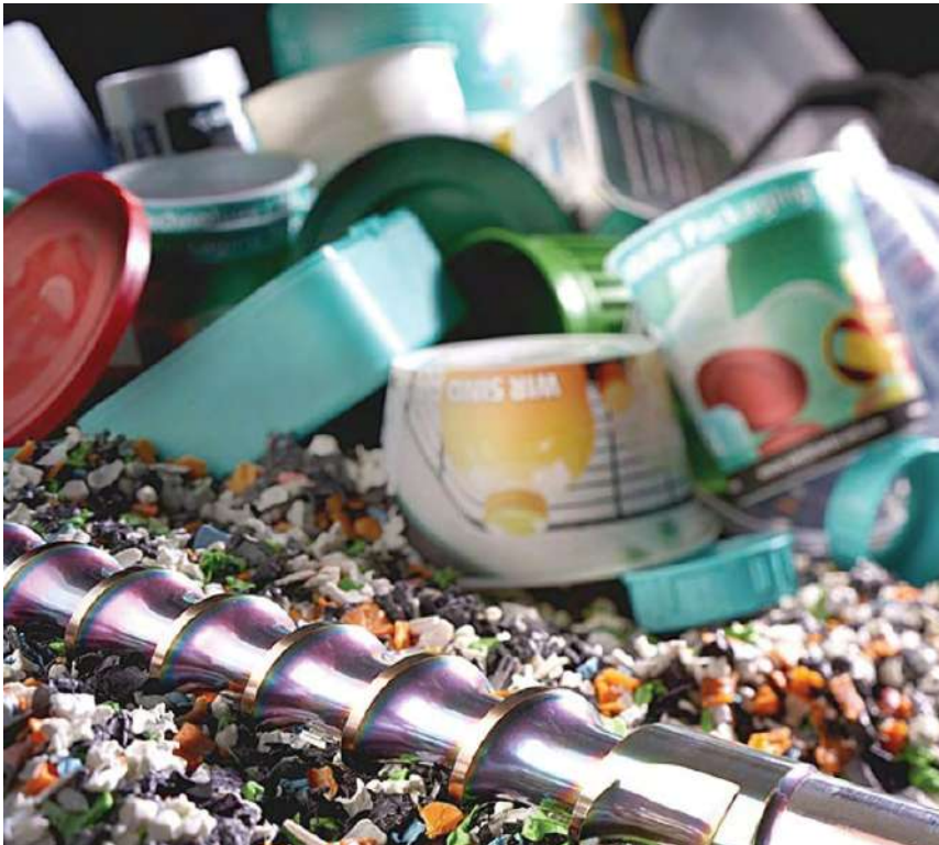
תמונה 1: פתרונות ARBURG כוללים ברגים בעלי גאומטריה של כריכות עמוקות וציפוי כרום ניטריל (CrN).
