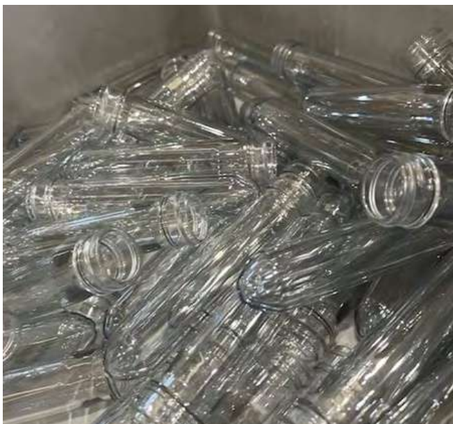
תמונה 1: מימין: מבחנות PET שהוזרקו מיד לאחר תהליך ה-Purge. משמאל: מבחנות לאחר 5 דקות של ייצור - תוך זמן קצר המבחנות שקופות ונקיות מצבע.
