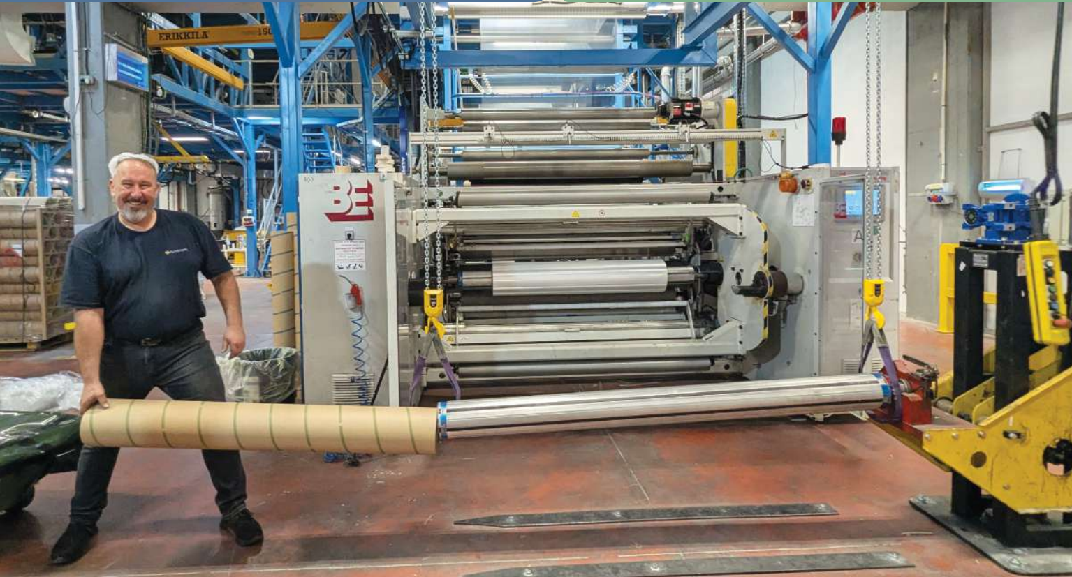
תמונה 2: החלפת גליל על קו תשע השכבות החדש של פולישק הנמצא באתר הזורע.
