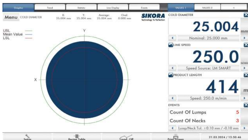
תמונה 2: מערכת הבקרה ECOCONTROL של ה-LM SMART מספקת נתונים בזמן אמת על אורך ומהירות הכבל או הצינור הנמדד.
