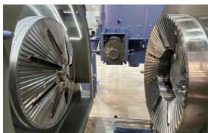
תמונה 2: מבט מקרוב על הדיסקות המשמשות לדחיסת החומר.
