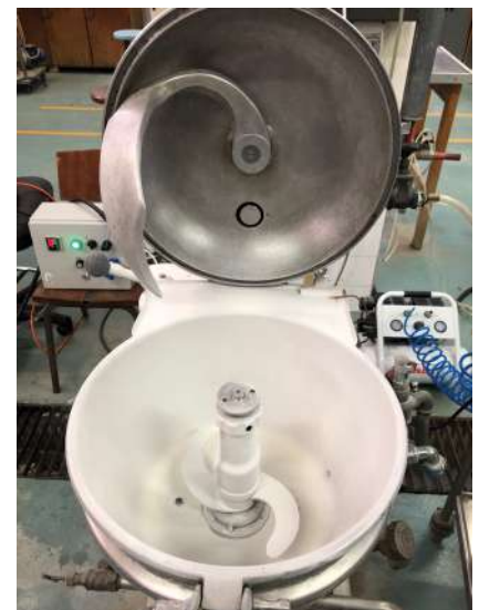
תמונה 2: ציפוי פנימי של KIINNS למיקסר ולסכין הערבוב, המוסר בסיום העבודה ללא צורך בניקיון.
