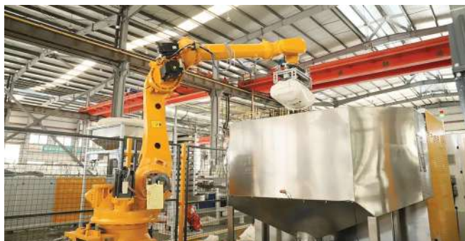
תמונה 2: מערך פריקת שקים אוטומטי מהיר של Mconvey.
