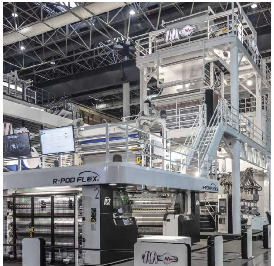
תמונה 1: קו האקסטרוזיה בניפוח של Macchi לחומרים ממוחזרים R-POD FLEX.
