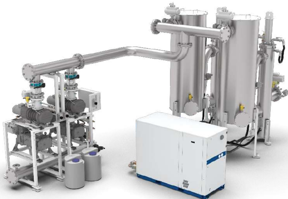
תמונה 2: מערכת PowerVac ליצירת וואקום דו שלבי המביא לחיסכון באנרגיה ומסייע בעבודה עם PET ללא ייבוש מקדים.
