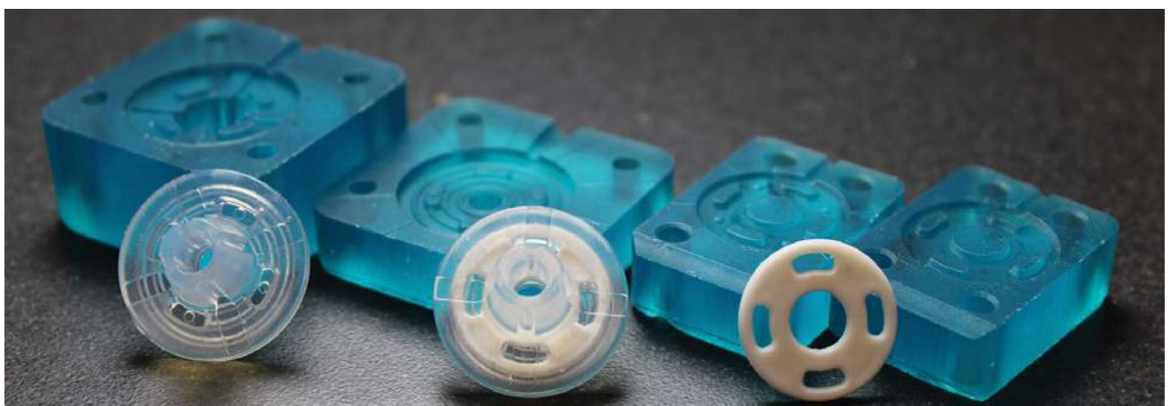
תמונה 1: חלקי פלסטיק שיוצרו בעזרת התבנית המודפסת מחומר xMOLD המתמוסס במים של Nexa3D.
