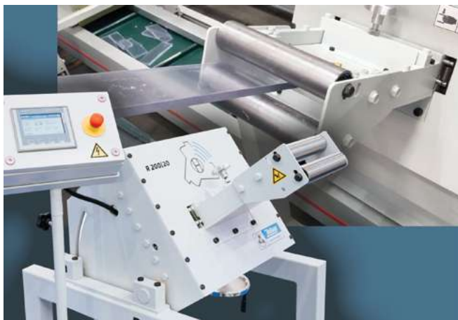
תמונה 2: מגרסת R 200/20 Servo לחיתוך שוליים של לוחות ויריעות.
