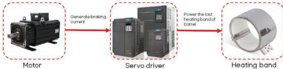
תמונה 3: מערכת שימור האנרגיה במכונות דור A6 החדשות. אנרגיה קינטית מועברת לחשמלית ומשמשת לגופי החימום בבורג.
