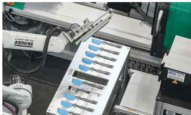
תמונה 2: מריות מאושרות למגע עם מזון בהזרקה דו-קומפננטית של LSR ו-PBT, עם ה-Allrounder More 2000.
