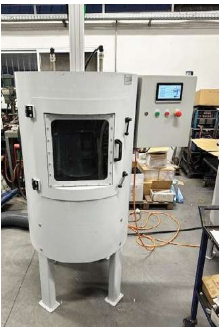
הכוללת תא אליו נכנס המסנן ועובר שטיפת אוויר בזרימה הפוכה, הן מבפנים והן מבחוץ.
