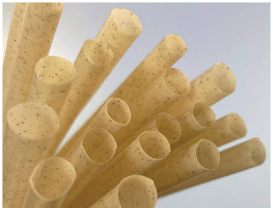
תמונה 1: אקסטרוזיה של קשיות שתיה עם החומר של Solinatra.
