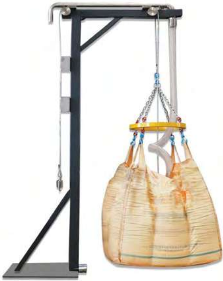
תמונה 2: מתקן לריקון אוטומטי של ביג-בגים ואוקטבינים מחברת Mconvey.
