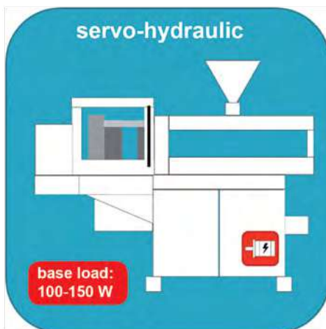
תמונה 1: מכונת הזרקה כל-חשמלית לעומת סרוו-הידראולית. החשמלית דורשת השקעת הספק אנרגיה בסיסי רב יותר להנעת מנועי הסרוו.
