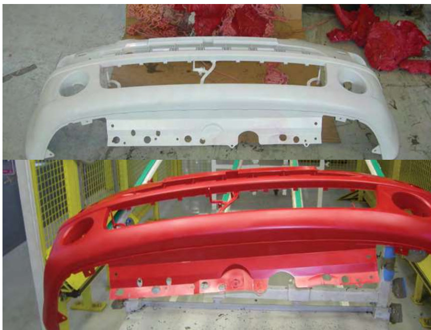
תמונה 1: ייצור של פגוש לרכב בצבעים שונים. מעבר הצבע התבצע במהירות הודות לחומר הניקוי Eko 801
