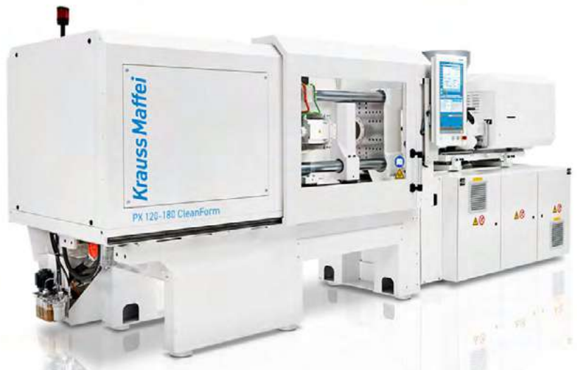
תמונה 1: מכונת הזרקה רפואית מסדרת PX עבור חדרים נקיים. לעבודה נקי, וחסכונית באנרגיה ובשטח רצפה.
