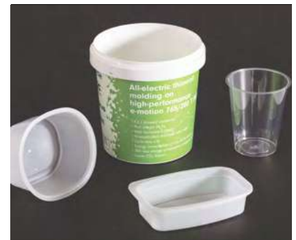
תמונה 2: הפתרונות שהציגה החברה בכנס. משמאל לימין: קופסת 250 גרם מוצרלה שהוזרקה ב-duo speed 500, דלי 1.3 ליטר שהוזרקה ב-e-motion 280 הכל-חשמלית, קופסת 150 גרם שהוזרקה ב-e-mac 180 הכל-חשמלית וקופסת 150 גרם שהוזרקה ב-e-speed 280 היברידיית.
