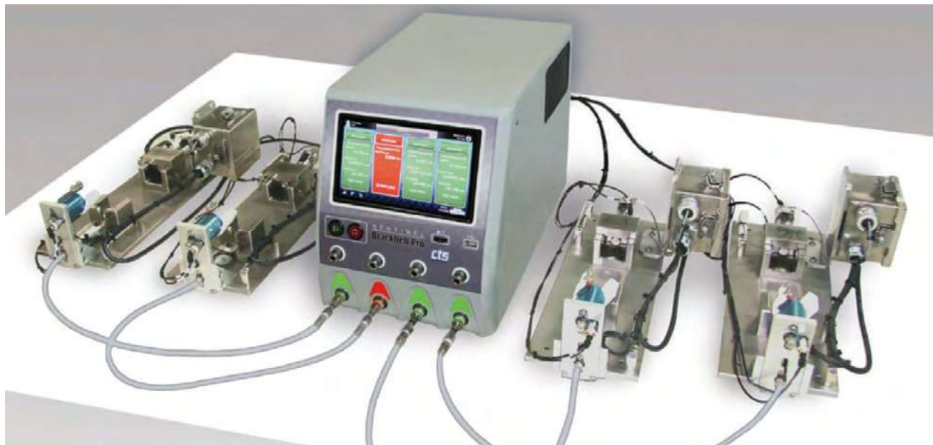
תמונה 3: ה-Sentinel Blackbelt Pro של CTS המשמש לבדיקת ירידת ואקום, ירידת לחץ ו-Mass Flow.
