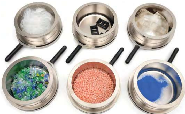
תמונה 2: HydroTracer מסוגל לבצע בדיקות גם עבור גרגירים, אבקה, סיבים ודגמים לא סטנדרטים.
