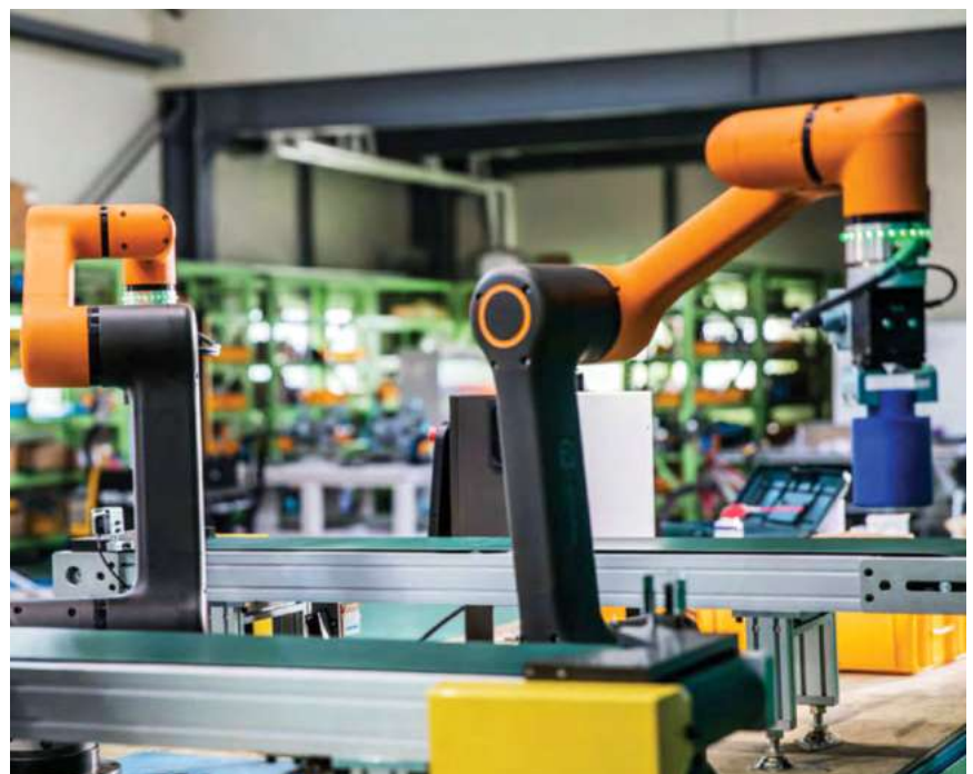
תמונה 1: רובוטים שיתופיים מסדרת HCR של Hanwha Robotics הקוריאנית מבצעים עבודות הרכבה.
