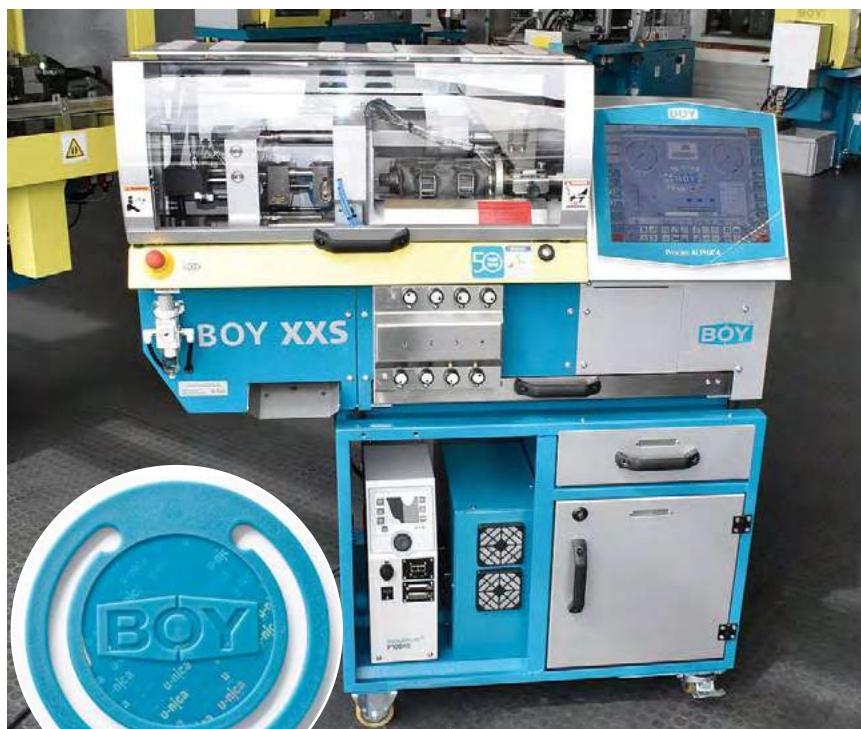
תמונה 1: מכונת הזרקה חלקים קטנים של BOY XXS של Dr. Boy. בתחתית המכונה משמאל בקר הטמפרטורה P100XS של Regloplas. בעיגול: תקריב של משטח מיקרוני המוזרק על ידי ה-BOY XXS. המבנה מאפשר שבירת אור ייחודית.
