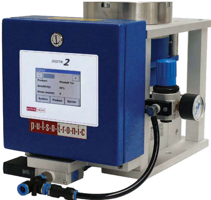
תמונה 1: סדרת Compact של Pulsotronic לזיהוי והפרדה של מתכות מחומר הגלם.
