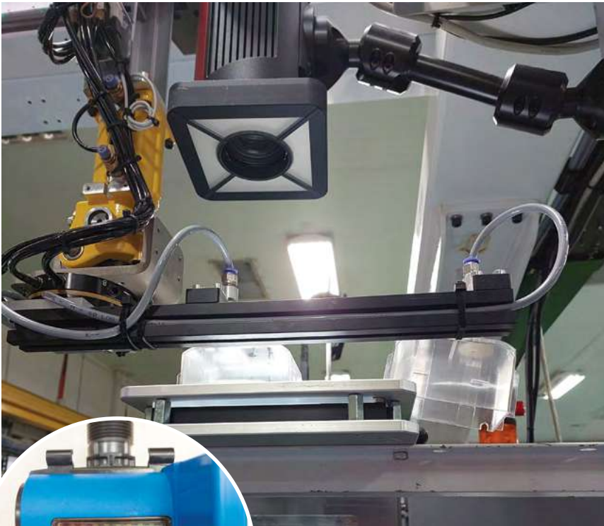
תמונה 1: מערכת ה-Vision של Inspekto בוחנת מכסים שקופים עבור מדי מים של קבוצת ארד. בעיגול - מד המים השלם.
