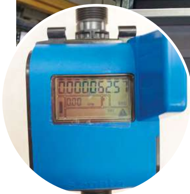
תמונה 1: מערכת ה-Vision של Inspekto בוחנת מכסים שקופים עבור מדי מים של קבוצת ארד. בעיגול - מד המים השלם.
