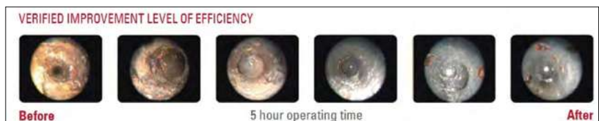
תמונה 2: תעלות קירור בתבנית במהלך ניקוי של 5 שעות. משמאל לימין: תעלה חסומה שמתחילה להיפתח.
