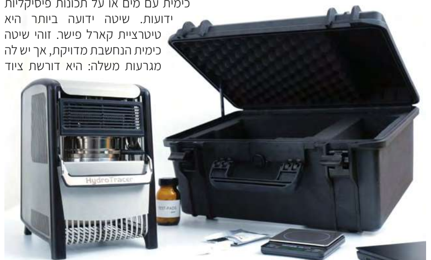
תמונה 1: מכשיר מדידת לחות אבסולוטית HydroTracer HT3 של חברת Aboni.
