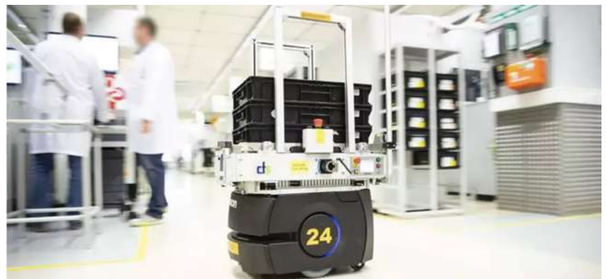
תמונה 1: רובוט נייד אוטונומי משנע חלקים כחלק ממערכת אוטומציה Smart Factory של cts.
