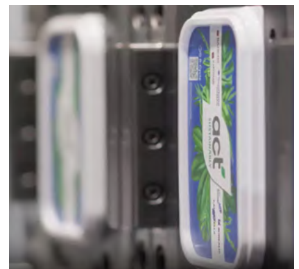
תמונה 2: מכסה דק דופן עם תווית IML מבוססת PP למיחזור מלא של האריזה עם התווית.
