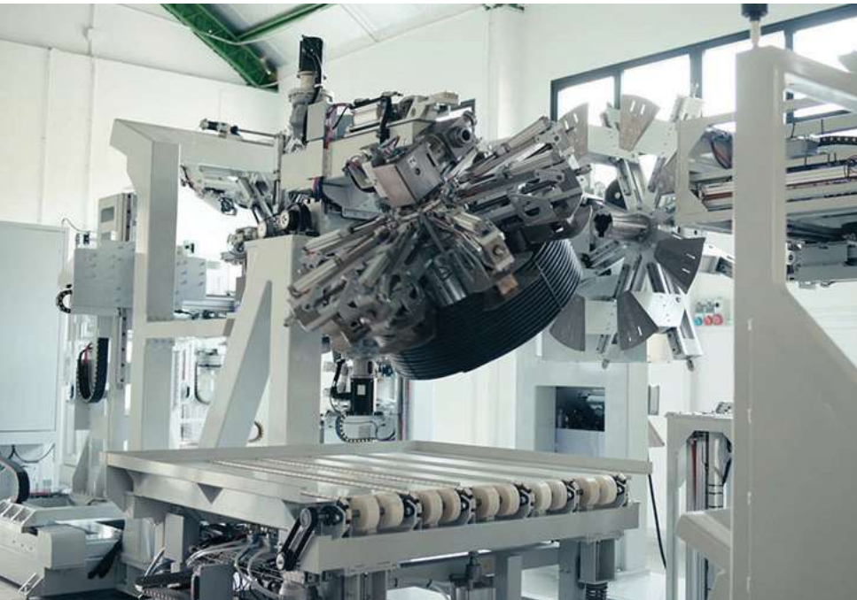
תמונה 1: מערכת גלילה אוטומטית של צינורות פלסטיק מסדרת CS2 של חברת Coiling System.
