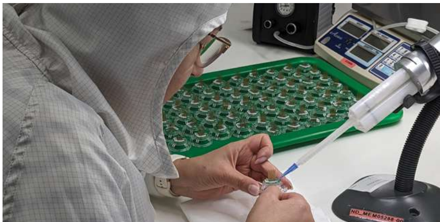
תמונה 2: הרכבת מכלול אלקטרוני על חלקי פלסטיק מוזרקים, בחדר הנקי של 3BY.
