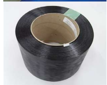
תמונה 1: UD Tapes של Mitsubishi. למטה: Reny Tape, סיבי פחמן שמרוכבים עם MXD6 ולמעלה: סרט על בסיס THERPLIM החדשני.
