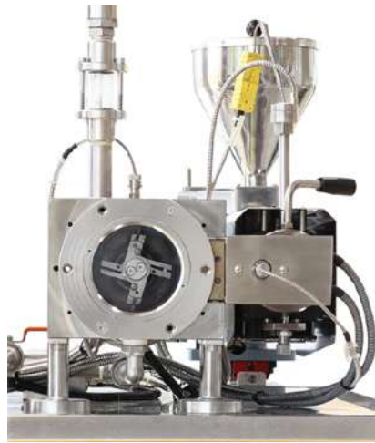
תמונה 2: בצד ימין: המערכת של גירעון תחת מים של קו התרכובת המעבדתי החדש של Labtech. בצד שמאל: מתקן הייבוש הצנטריפוגלי.
