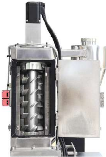
תמונה 2: בצד ימין: המערכת של גירעון תחת מים של קו התרכובת המעבדתי החדש של Labtech. בצד שמאל: מתקן הייבוש הצנטריפוגלי.
