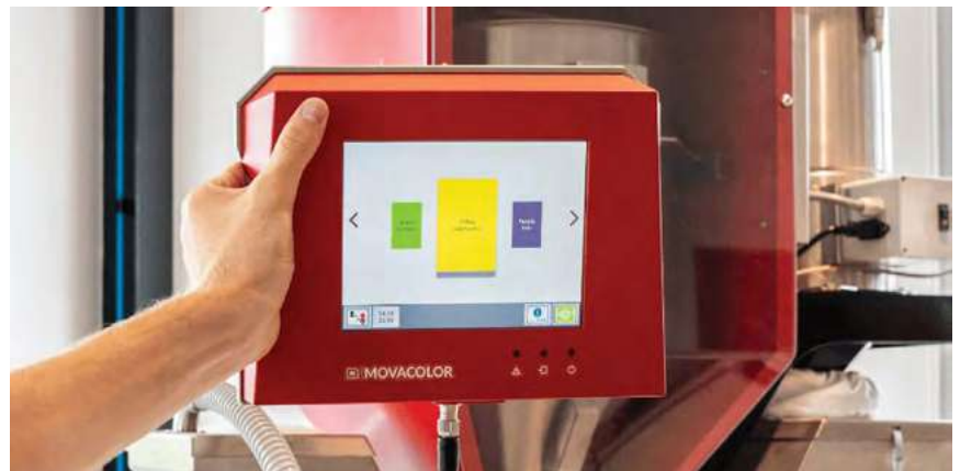
תמונה 1: בקר נייד חדש, Portable Touchscreen Controller (PTC), אשר יושק בתחילת 2024.
