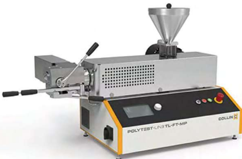
תמונה 1: מכשירי Pressure filter test מתוצרת Collin. משמאל - גרסה סטנדרטית. מימין - גרסה אוטומטית לבדיקות בזמן אמת על רצפת הייצור.
