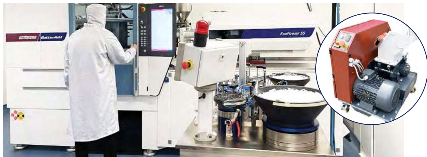
תמונה 1: החדר הנקי עם מכונת ההזרקה EcoPower 55 הקומפקטית. בעיגול: הגרנולטור G-Max 9 אשר הותקן מתחת למכונת הייצור.
