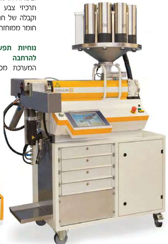
תמונה 1: מכשירי Pressure filter test מתוצרת Collin. משמאל - גרסה סטנדרטית. מימין - גרסה אוטומטית לבדיקות בזמן אמת על רצפת הייצור.
