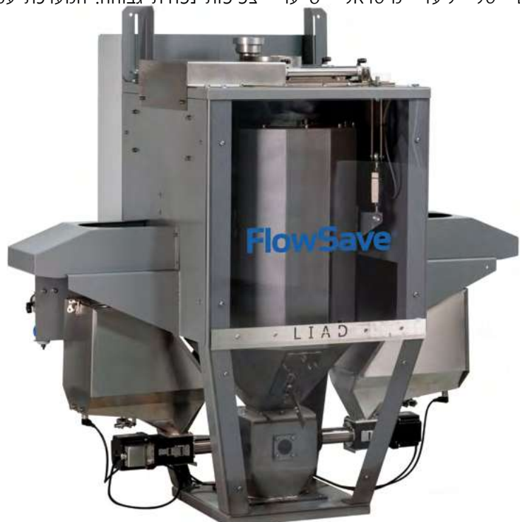
תמונה 1: מערכת FlowSave אשר תותקן בחברת Modiform בהולנד.
