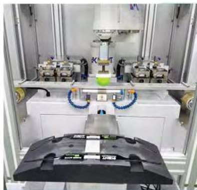
תמונה 1: KENT משיקה תא רובוטי חדש הכולל רובוט SCARA להדפסת טמפון.
