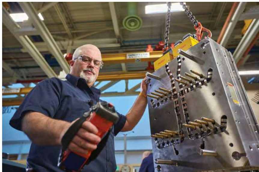
תמונה 2: התקנה של מערכת ראגרים חמים המצוידת בטכנולוגיית UltraSeal של HUSKY למניעת דליפות היתך.
