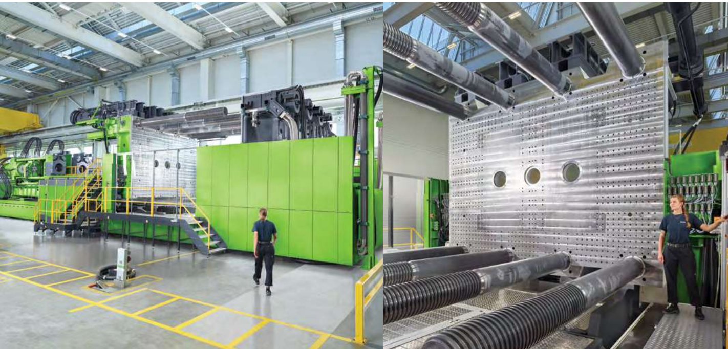
תמונה 2: מגה מכונת ייצור ENGEL Duo בעלת כוח נעילה 8000 טון, ותבנית מתאימה.
