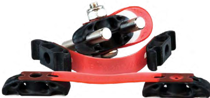
תמונה 1: מהדק (clamp) לצנרת במטוס F-16 אשר הודפס בטכנולוגיית DLP במדפסת Origin One P3.
