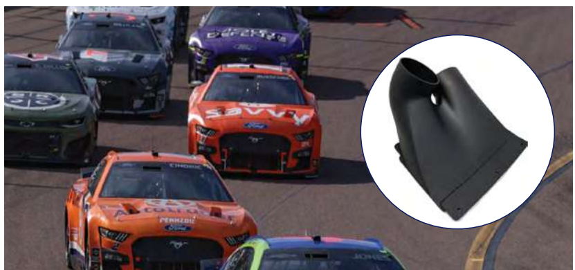
תמונה 1: חלק רכב שפותח במהירות לקראת תחרות Nascar והודפס בטכנולוגיית SAF. החלק כיום משמש כמוצר סופי במכוניות Nascar Next Gen.
