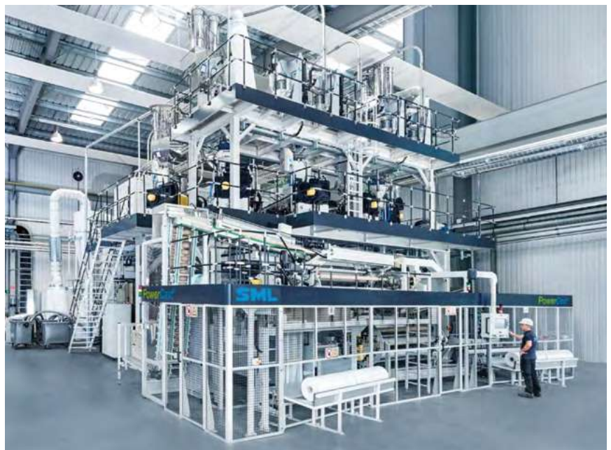
תמונה 1: PowerCast XL לייצור יריעות ברוחב של עד 4.5 מטרים מתוצרת SML.
