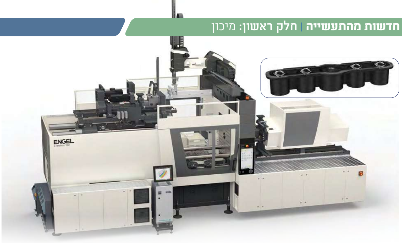
תמונה 1: מכונת הזרקה חשמלית M 160 combi e-motion לייצור דו-קמפוננטי של חלק המשמש לאבחון דיאגנוסטי בתעשיית המדיקל.
