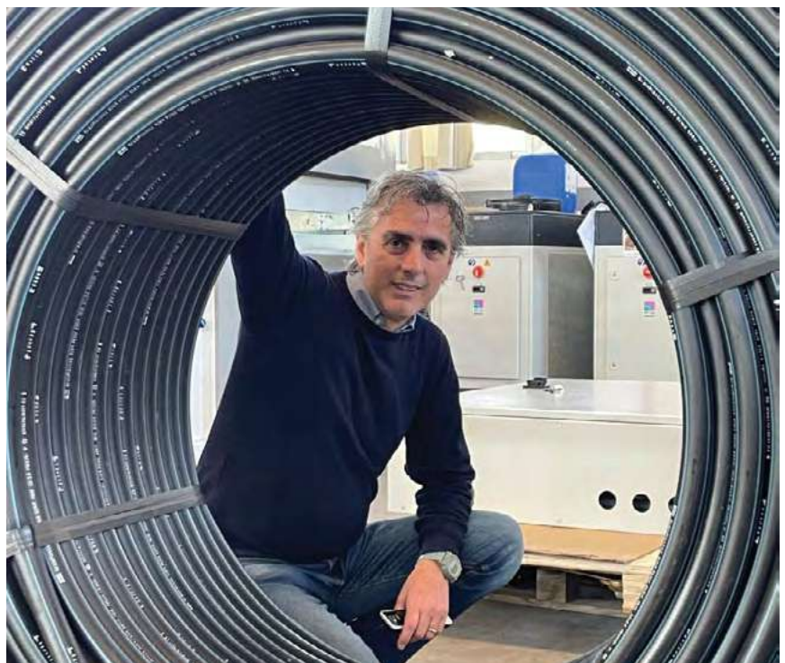
תמונה 2: סליל מאוחן ויציב ממדי שנואר על ידי ה-Smartcoil באמצעות שש רצועות פלסטיק.
