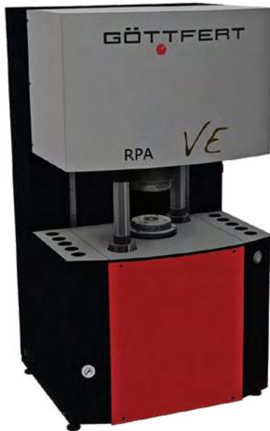
תמונה 2: מכשיר ה-RPA מבית GÖTTFERT למדידת סיעוף של פולימרים.
