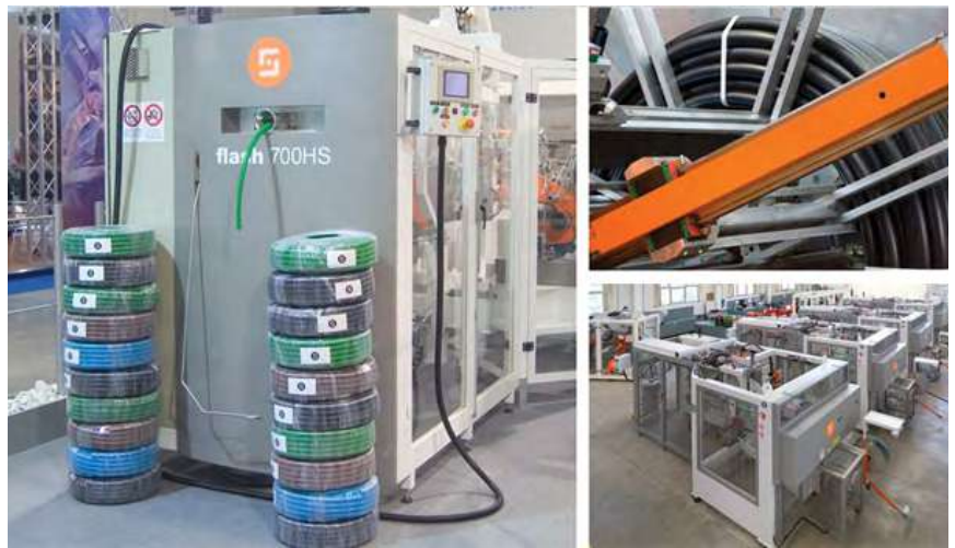
תמונה 1: ה-Smartcoil בפעולה - אורז צינורות גמישים חלקים באמצעות יריעה.
