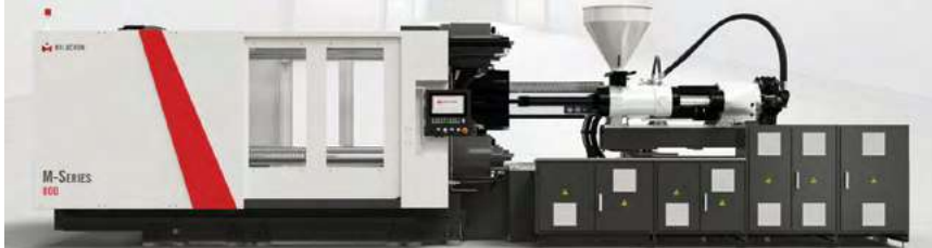
תמונה 3: סדרת מכונות הזרקה סרבו הידראוליות מהירות M-Series במבנה של שתי פלטות, המיוצרות בקומפלקס של Milacron בהודו.
