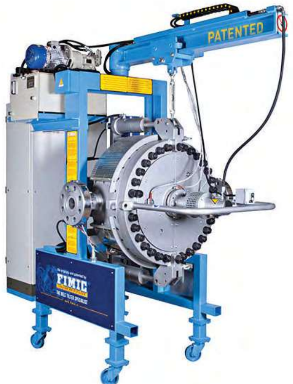
תמונה 1: מסנן היתך מדגם RAS בעל מנגנון החלפה אוטומטי מבית FIMIC.
