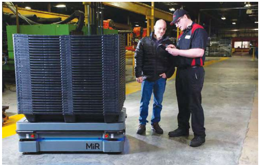
תמונה 1: עגלה אוטונומית MiR500 במפעל Cabka Group לשינוע משטחים מחומרים ממוחזרים.
