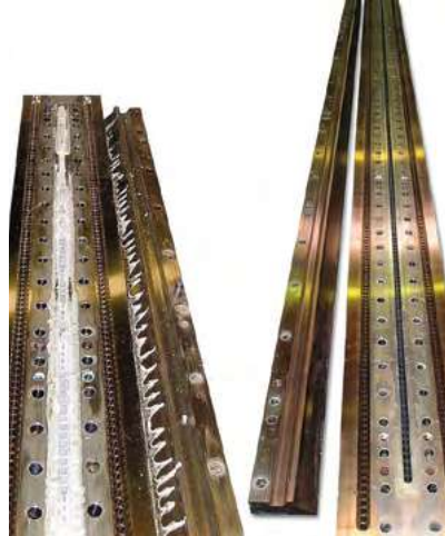
תמונה 2: דירת אקסטרודיה לפני ואחרי ניקוי ב-VACUCLEAN מבית חברת SCHWING.
