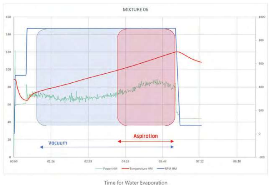
תמונה 1: זמן אידוי המים בעבודה עם מיקסר חם משולב וואקום (כחול), או עם מיקסר חם בלחץ אטמוספרי (אדום).
