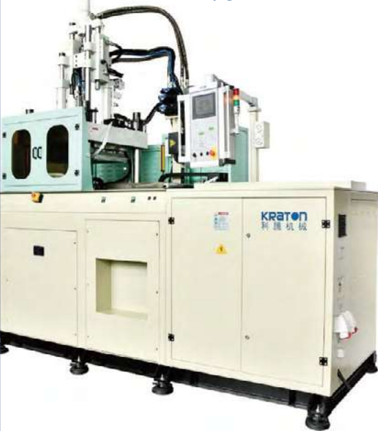
תמונה 1: מימין - KT-20/200KG-2S מערכת מינון ל-LSR, משמאל - מכונת הזרקה אנכית מסדרת KTVC מיועדת לתעשיית המדיקל, מוצרי צריכה ועוד.
