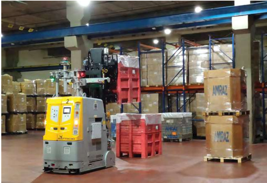
תמונה 3: הכנת משטחים של תוצרת גמורה לסידור במחסני אמרז על ידי הרובוטים האוטומטיים.
