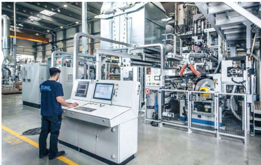
תמונה 2: קו FlexPack לציפוי יריעות בקו-אקסטרוזיה ולמינציה.
