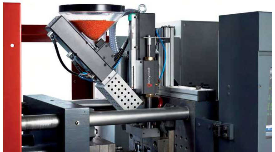
תמונה 2: יחידת ההזרקה האוטונומית החשמלית Babyplast UAI.
