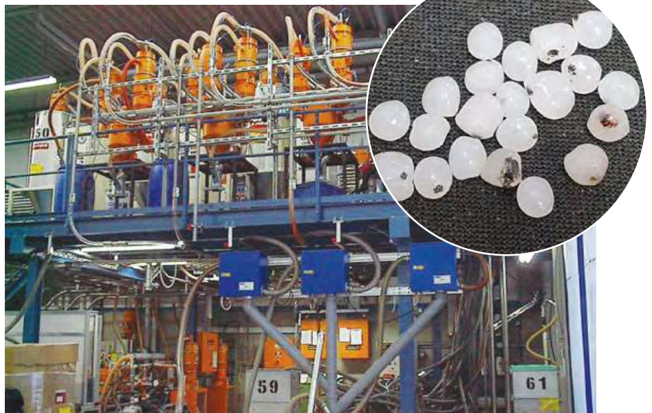
תמונה 1: שלושה Extraktor-ים מבית PULSOTRONIC בפעולה. בעיגול חומר גלם בתולי המכיל זיהום מתכת.
