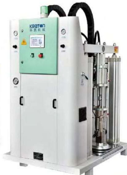
תמונה 1: מימין - KT-20/200KG-2S מערכת מינון ל-LSR, משמאל - מכונת הזרקה אנכית מסדרת KTVC מיועדת לתעשיית המדיקל, מוצרי צריכה ועוד.
