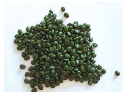
תמונה 1: למעלה - מבנה הדשא הסינתטי. למטה - התוצר הסופי: גרגרי PE/PP באיכות מעולה.
