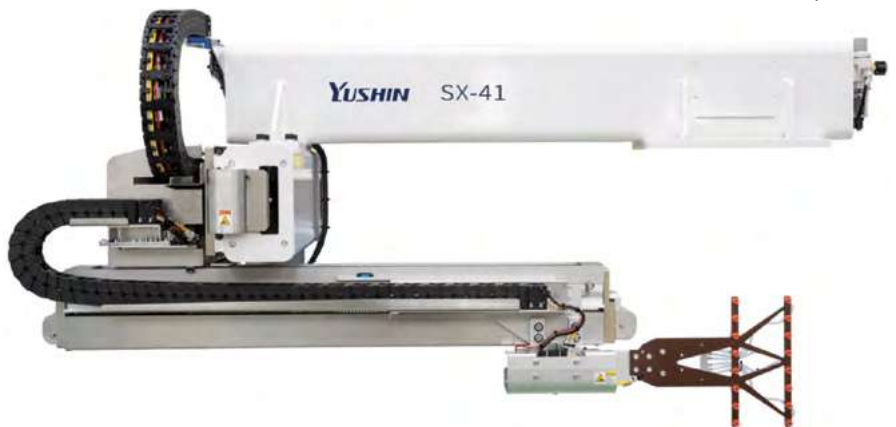
תמונה 1: SX-41 מבית YUSHIN יפן. מהיר במיוחד לעבודה בתנאי ISO Class 6.
