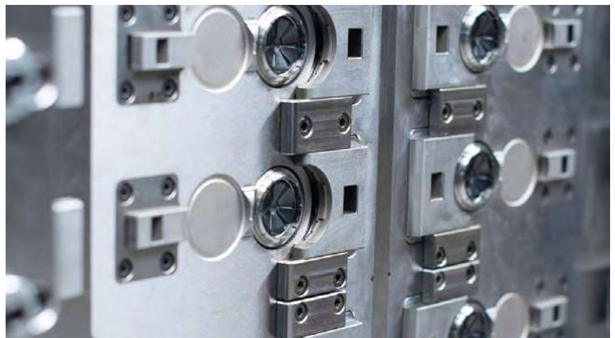
תמונה 1: תבנית מרובת מובלעות לייצור פקקים מבית htw, אוסטריה.
