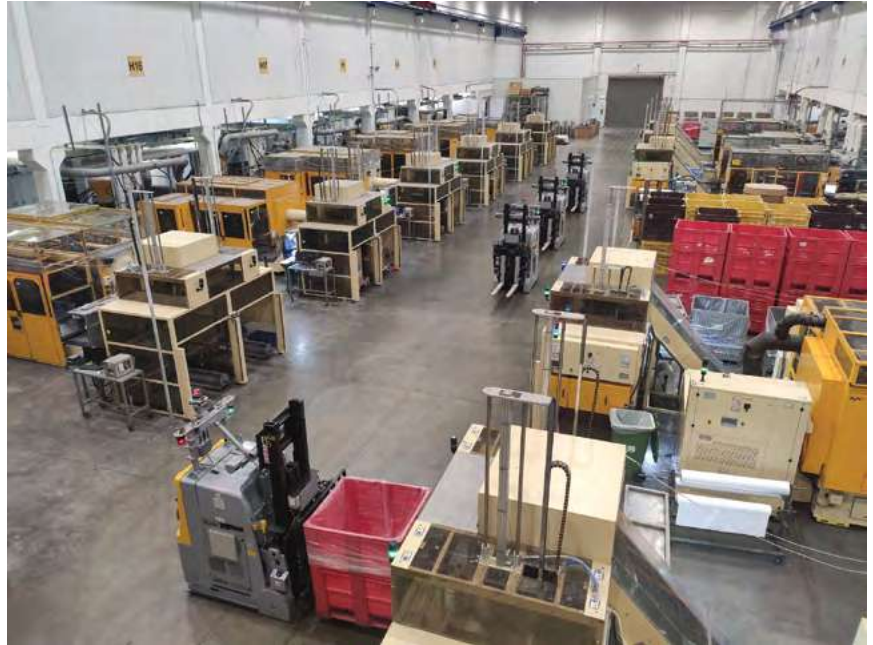
תמונה 2: מכונות ההזרקה ברצפת ייצור השפופרות באמרז. עבודה אוטומטית לחלוטין ללא כוח אדם אנושי.
