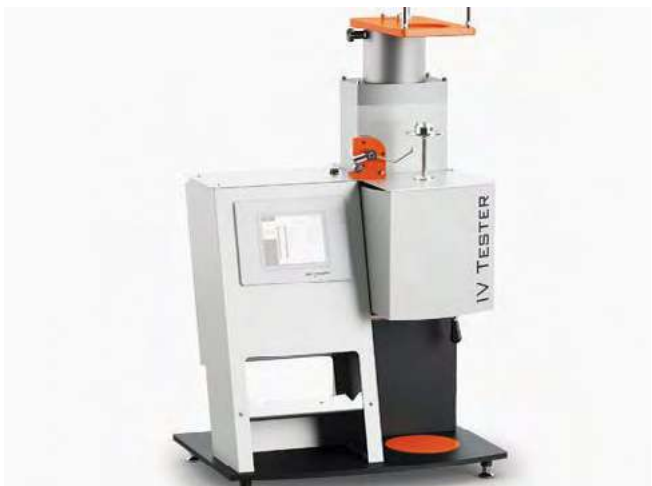
תמונה 1: מכשיר ה-IV Tester למדידת צמיגות עצמית.
