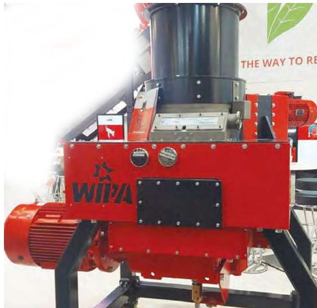
תמונה 1: מערכת Plast Compactor לייצור אגלומרטים מפסולת פלסטיק, אשר הוצגה בתערוכת K2022.
