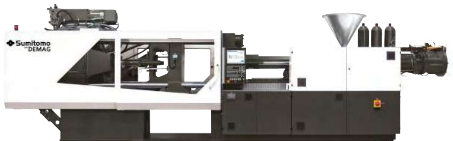
תמונה 1: מכונת הזרקה היברידית ליישומים רפואיים El-Exis SP 420 טון, למחזורי הזרקה מהירים במיוחד מבית DEMAG (shi) Sumitomo.
