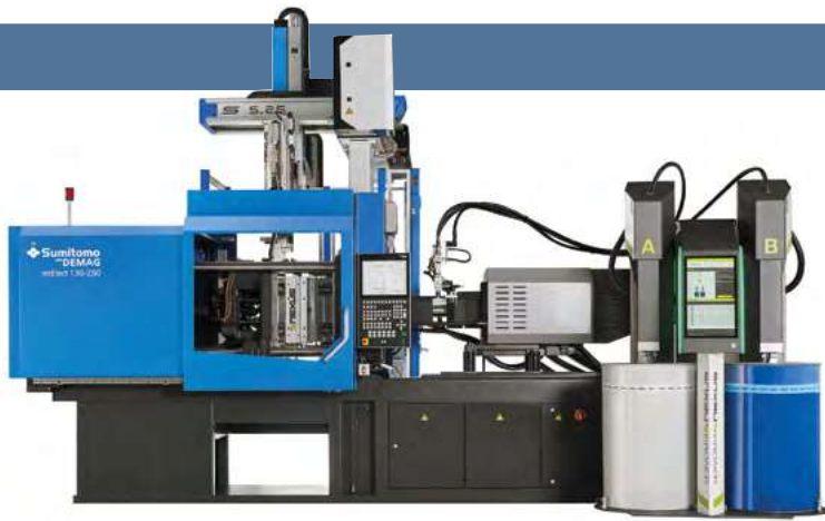
תמונה 2: מכונת הזרקה חשמלית מסדרת IntElect לחלקי LSR עם רובוט, שניהם מתוצרת Sumitomo DEMAG (shi). המכונה כוללת מערך מינון מתוצרת NEXUS.
