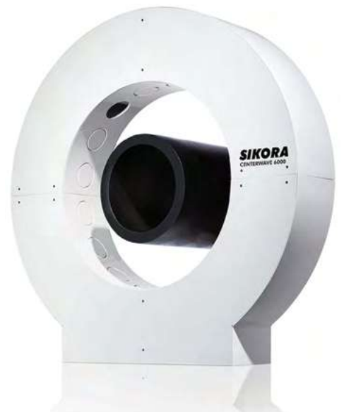
תמונה 1: מימין - המערכת מבית SIKORA מדגם CENTERWAVE 6000. משמאל - צילום מסך מהמערכת המבוססת על טכנולוגיית גלי רדיו לניטור שכבות גבול בצינור.
