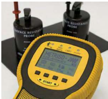
תמונה 2: מדידת התנגדות משטחית של פלסטיק מוליך, חברת Delta Kunststoffe הגרמנית.
