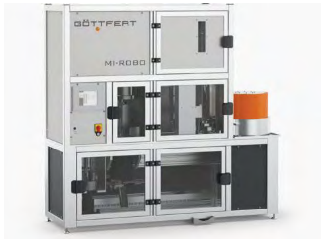
תמונה 2: MI ROBO - מערכת למדידה אוטומטית לחלוטין של בדיקות MFI רבות.
