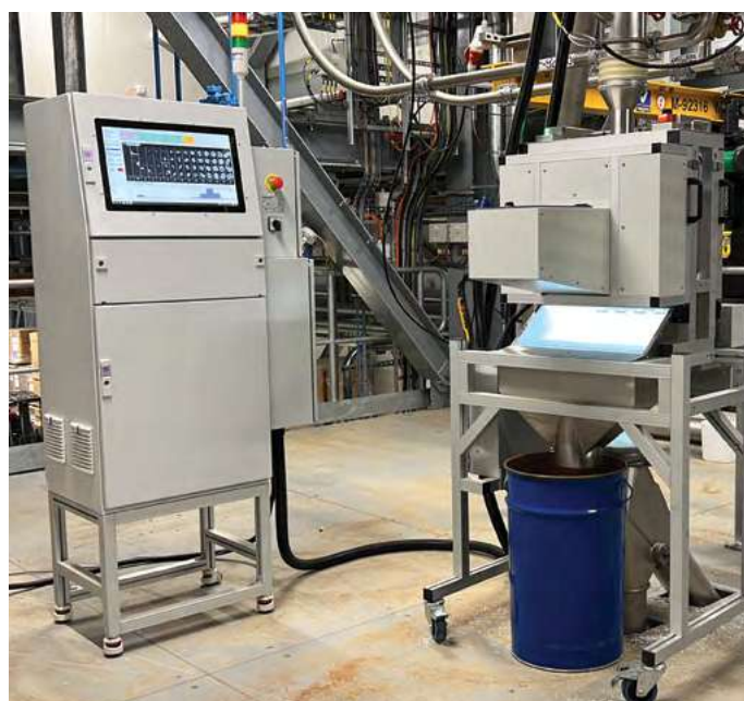
תמונה 5: מערכת מדגם RMI11 לניטור בקו ייצור חומר גלם באירופה בתפוקה של 2.8 טון בשעה, מבית inspect.tech.
