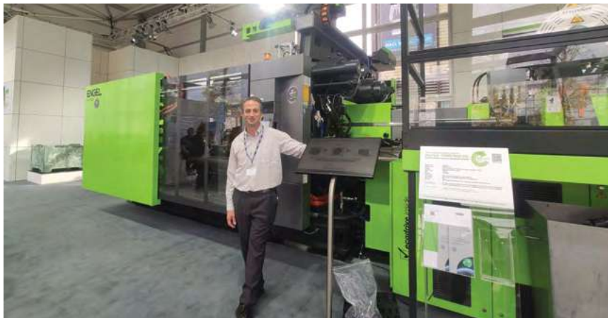
תמונה 3: הבל ירוחוביץ', מנהל תמיכה טכנית בארן, נציגת ENGEL בישראל, לצד מכונת ההזרקה Duo 900, המשלבת אקסטרודר לעיבוד PCR.
