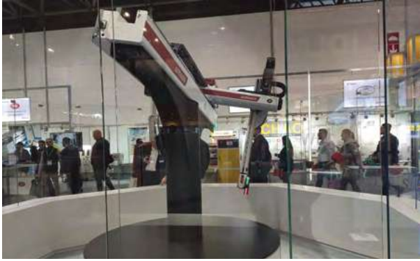
תמונה 3: רובוט קרטזי Wx142 שישה צירים מהסדרה החדשה. מגיע עם מערכת הפיקוד של Wittmann מסדרה 9.
