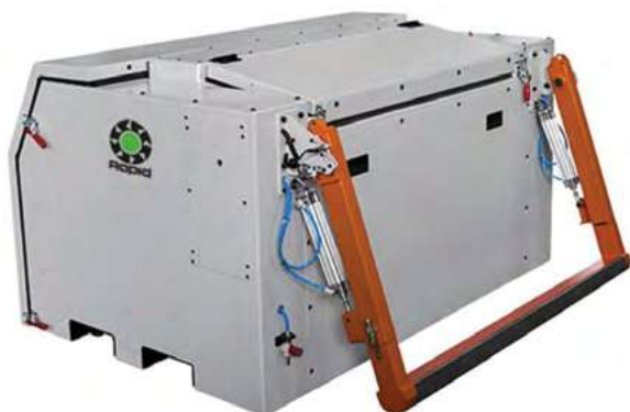
תמונה 2: GT1100 - המגרסה החדשה לגריסה אונליין של שאריות תרמופורמינג.
