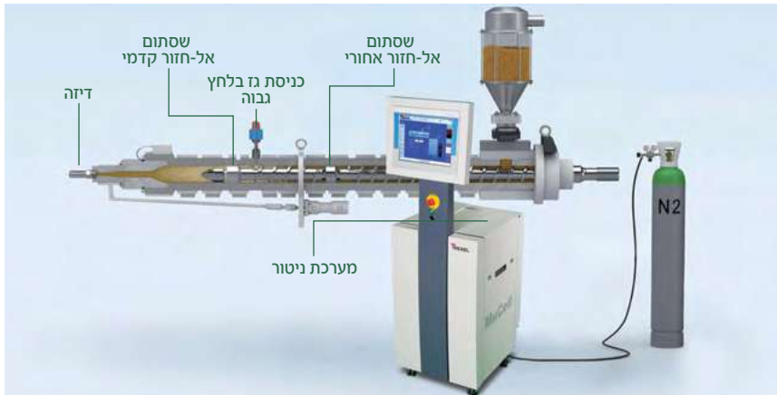
תמונה 1: תרשים סכמתי לשילוב מערכת הקצפה פיזיקלית MuCell של TREXEL בתהליך ההזרקה.
