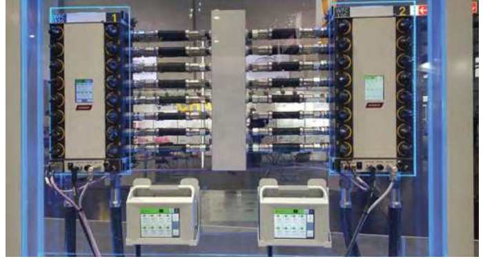
תמונה 2: ווסתי זרימה עם תצוגה דיגיטלית, המחליפים "חנוכיות".
