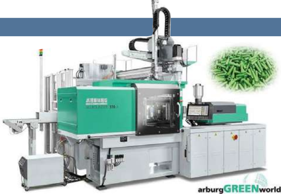
תמונה 2: מכונת הזרקה החשמלית Allrounder 370 A עם חבילת המיחזור. תייצר דיבל עבור חברת Fischer מחומרים ממוחזרים.
