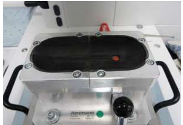
תמונה 1: מתקן הקיבוע מבית Herrmann Ultrasonics. עשוי חומר צפוי קשיח משרף ייחודי המשך ויברציות ומקבע את החלקים הדורשים ריתוך.
