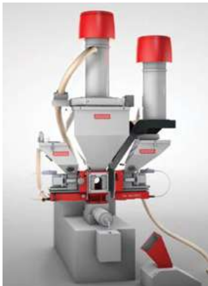
תמונה 1: מערכת-MCTwin המודולרית של MOVACOLOR כוללת מכל הזנה לצבע במילוי ידני, מכל הזנה לחומר גרוס המחובר למגרסה לצד מכונת הייצור ויחידה גדולה יותר לחומר גלם בתולי.
