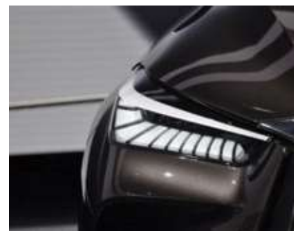
תמונה 1: חלקי פנס שיוצרו מ-LEXAN HF4010SR, המאפשר דיקוק חלקים והפחתת השימוש בפלסטיק.
