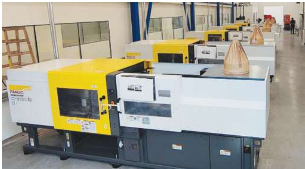
המכונות מדגם החדש FANUC ROBOSHOT -Alpha S-iB מצוידות במסך חדש בגודל 21.5 אינץ' HI-PRO.
