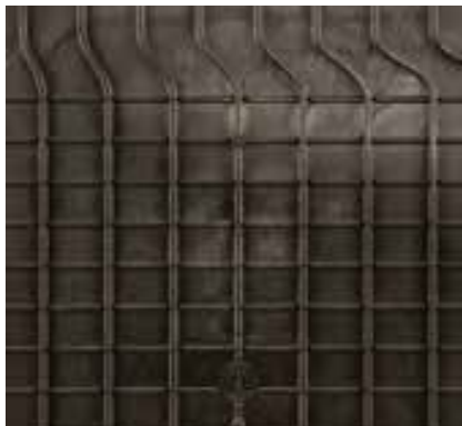
תמונה 3: פלטה של מחליף חום העשויה תרכובת LUVOCOM מוליכות תרמית.
