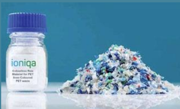
תוצר תהליך המיחזור הכימי החדשני של ioniqa: גרגרי PET ממוחזר חסרי צבע שמקורם בפסולת PET צבעונית. תמונה באדיבות K-Preview.
