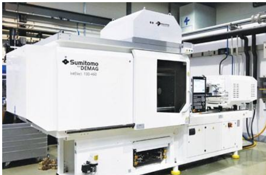
תמונה 2: מכונות הזרקה IntElect מבית DEMAG לייצור חלקים רפואיים.
