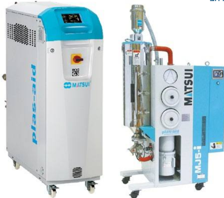
תמונה 1: מימין: ה-MJ5-i - מערכת ייבוש חסכונית באנרגיה עם דסיקנט מתחלף. משמאל: ה-MCX2 - בקר טמפרטורה המשלב צ'ילר ויחידת חימום. שניהם מבית MATSUI היפנית.
