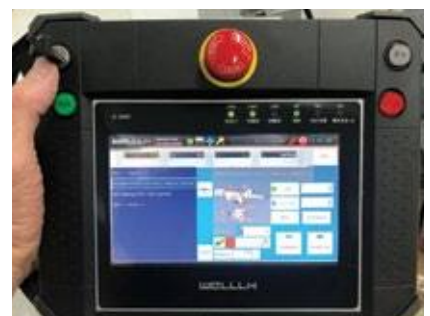
תמונה 1: מערכת התיכנות הידידותית של הרובוט, העברה פשוטה מהמחשב לעמדת המפעיל.
