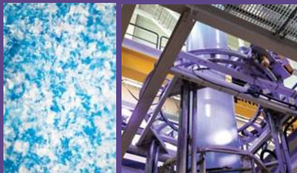
קו ניפוח Evo fusion, המשלב אקסטרודר דו בורגי לייצור יריעה ישירות מפתיית חומר גרוס.
