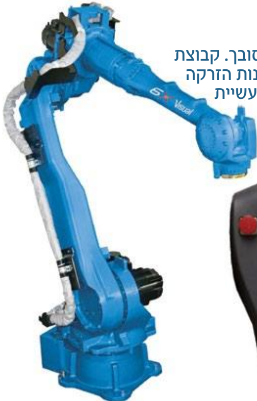
תמונה 1: רובוט שישה צירים מסדרת SEPRO-YASKAWA, לצד מערכת הבקרה Visual3.
