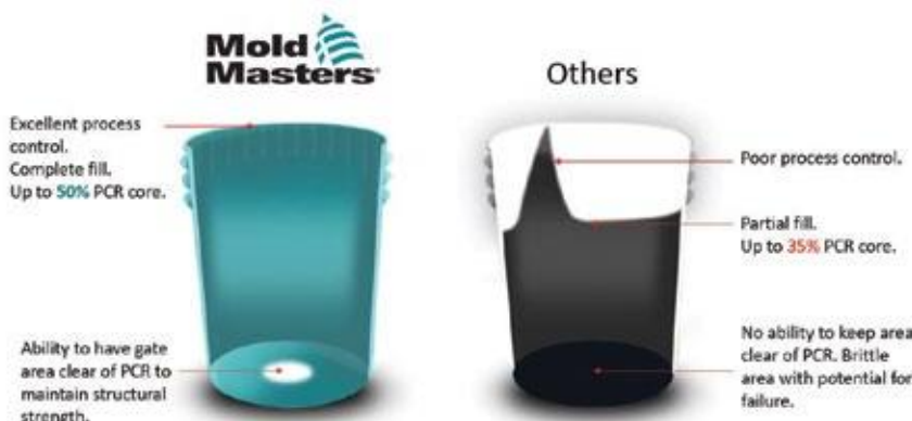
תמונה 3: השוואת מכל המכיל שכבת חומר ממוחזר שיוצר בטכנולוגיה של Mold-Master בהשוואה למיכל שיוצר בטכנולוגיה מתחרה
