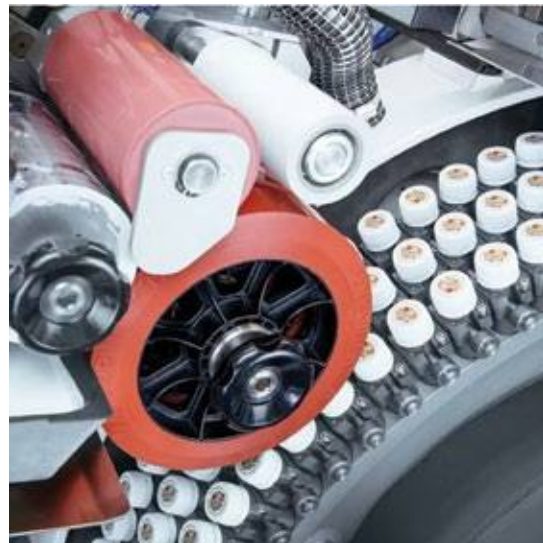
תמונה 2: הדפסת פקקים במכונה האוטומטית ROTOPRINT של TAMPOPRINT. תמונה 3: דוגמה לדפוס שנוצר בשילוב שפעול פני השטח בלייזר לפני תהליך דפוס הטמפון.
