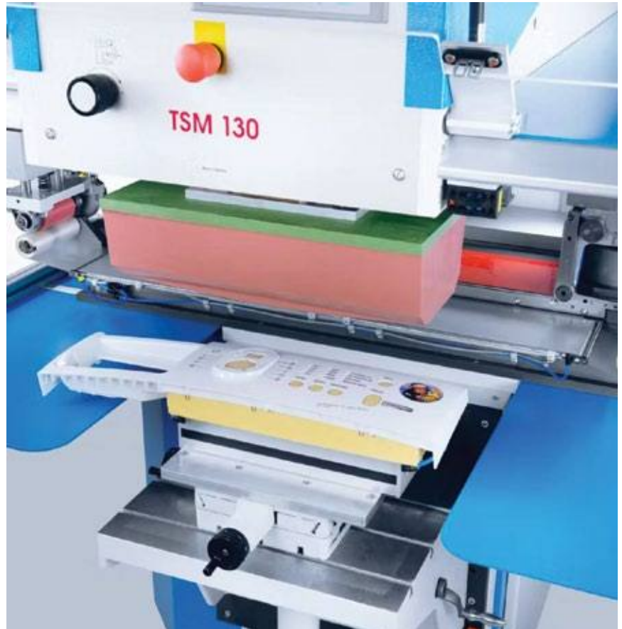
תמונה 1: מכונת דפוס טמפון מסדרת CONCENTRA מבית TAMPOPRINT.
