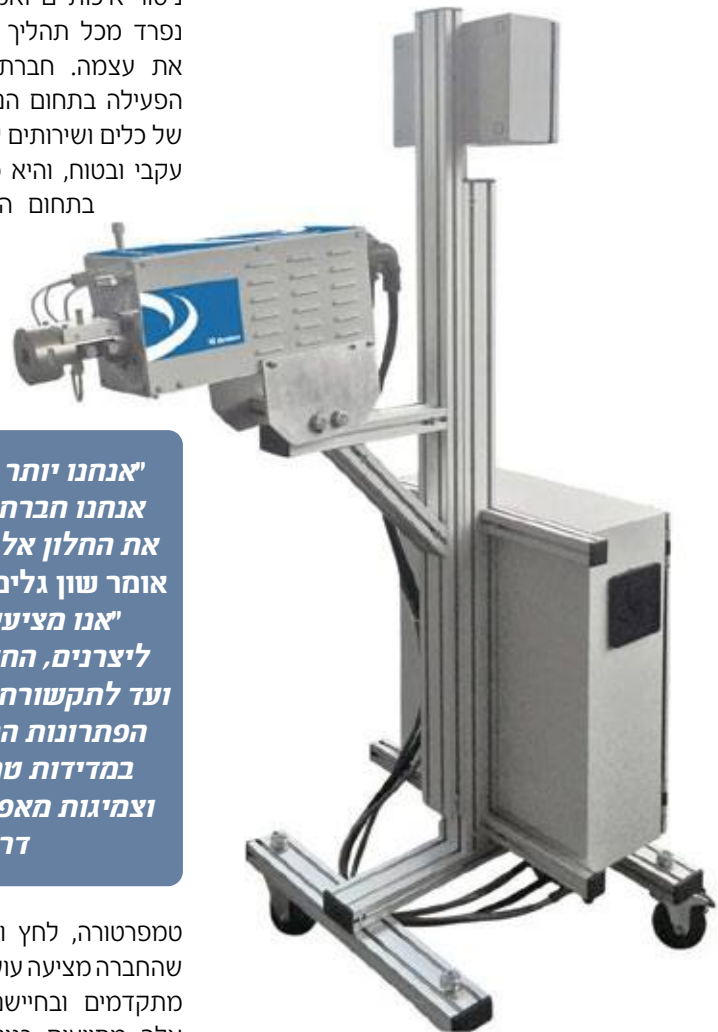
תמונה 1: ראוטר למדידת צמיגות און-ליין, מבית Dynisco. ניתן לחיבור ישירות לאקסטרוזרים, ריאקטורים ומערכות עיבוד פולימרים.
