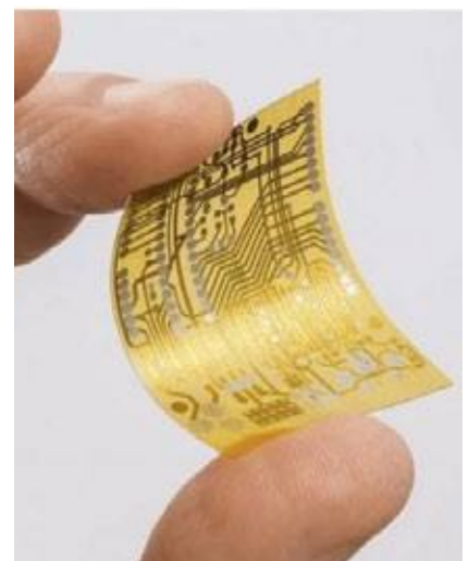
תמונה 1: מעגל חשמלי מודפס במדפסת תלת ממדית של חברת Nano Dimension.
