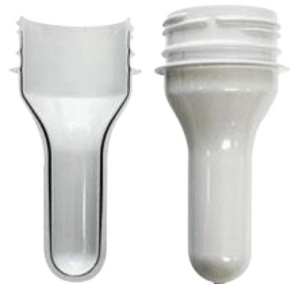
תמונה 2: מוצר מוזרק רב שכבתי בעל ליבה שחורה לחסימת מעבר אור, שיוצר במערכת ההזרקה הייעודית של חברת Mold-Masters.
