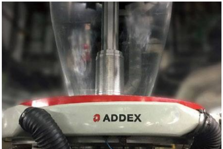
תמונה 1: טבעת הקירור ic של ADDEX מותקנת על אקסטורדר לשיפור יציבות הבלון והתפוקה.
