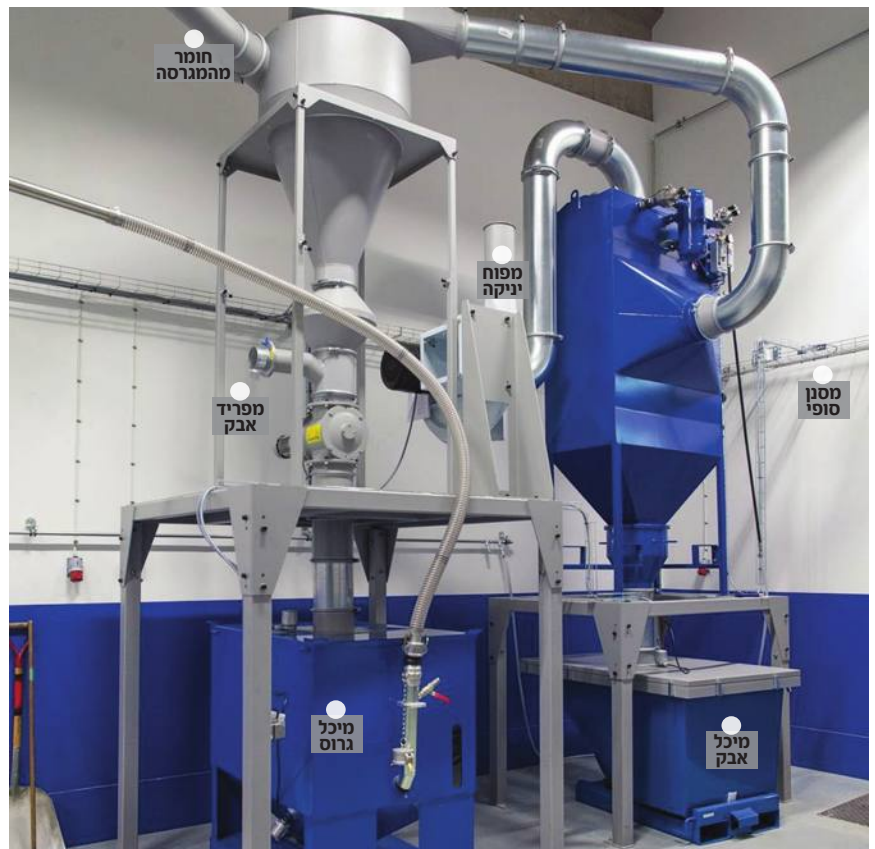
תמונה 2: מערכת NPDS להפרדת אבק הפועלת בעיקרון לחץ שלילי. מתאימה לתקן עבודה BIA Class M.
