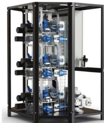
תמונה 1: פנים וחוזן של המערכת המודולרית SIGMA למדידת לחץ גבוה בצנרת.
