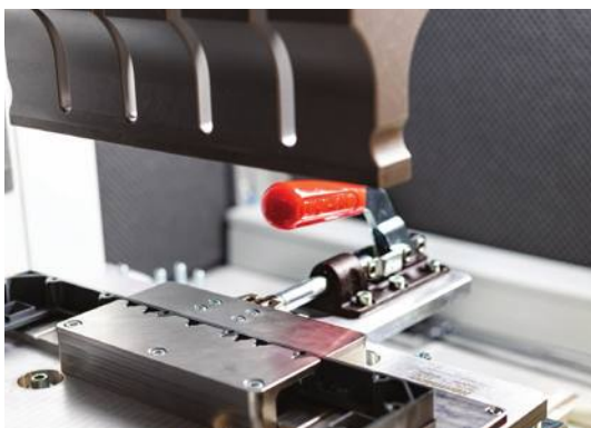
תמונה 2: מסגרת הפלסטיק מהודקת במתקן שפותח במיוחד לתהליך הריתוך להטמעת הברגות הפליז באופן מלא ואחיד.
