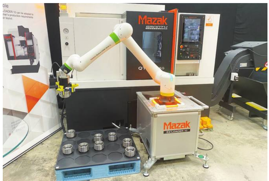
תמונה 1: הקובוט CRX-10iA/L, בעל משקל משא מקסימלי של 10 ק"ג בפעולה: טעינה/פריקה חלקים במחרטת CNC.
