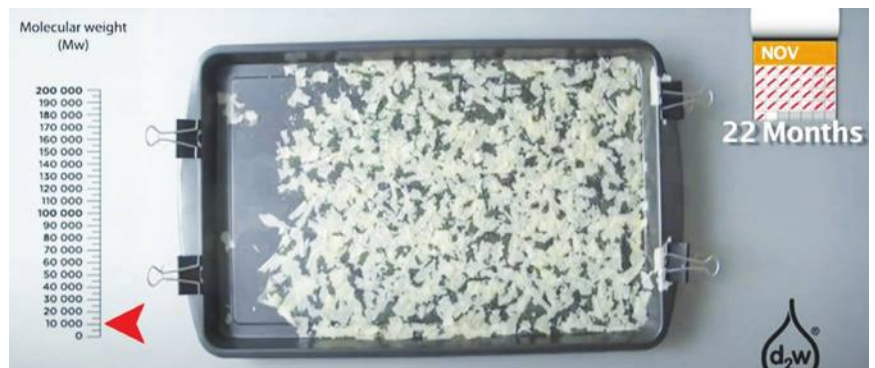
תמונה 1: שקית מפלסטיק אוקסו-ביו מתכלה (OBP) בתחילת הבדיקה (למעלה). אותה שקית לאחר 22 חודשים בתנאים המדמים סביבה פתוחה (למטה).
