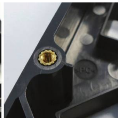
תמונה 1: הברגה נקבית לפני (משמאל) ואחרי תהליך הריתוך (מימין). הטבעה מלאה ואחידה של החיבורים לתוצר סופי אופטימלי.
