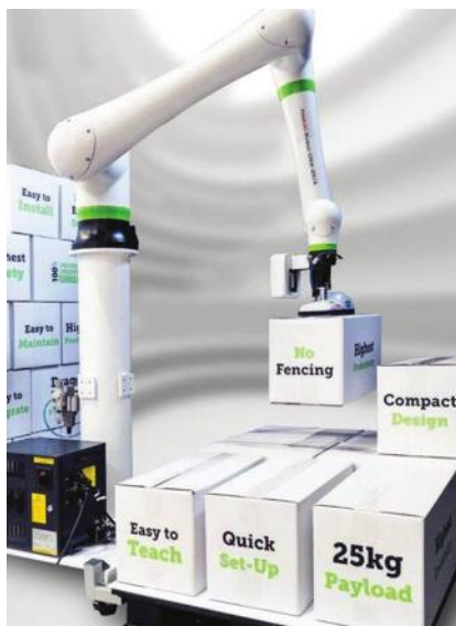
תמונה 2: הקובוט החדש CRX-25iA, בעל משקל משא מקסימלי של 25 ק"ג בפעולה: משטוח קרטונים.
