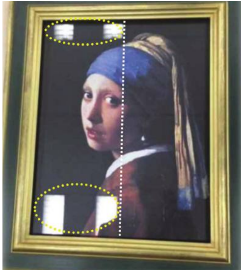
תמונה 3: המחשה לתפקוד יריעה למניעת החזרי אור מתוצרת MITSUBIHI CHEMICALS, מימין - עם יריעת MOSMITE, משמאל - ללא.
