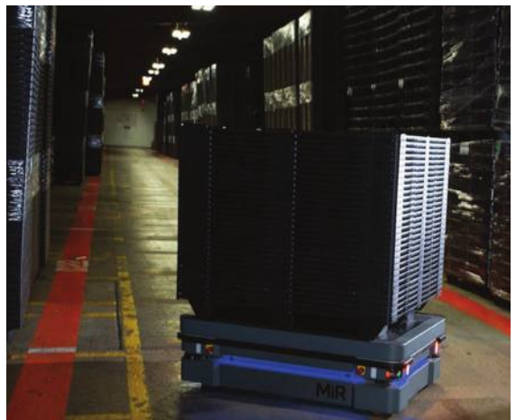
תמונה 1: עגלת MiR500 משנעת משטחים המיוצרים בחברה Cabka שבמיזורי, ארה"ב.
