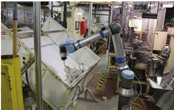
תמונה 2: קובוט עם יישום Bin picking מעביר מוצרים בין עמדות בייצור בחברת Allied Moulded product שבאוהיו, ארה"ב.
