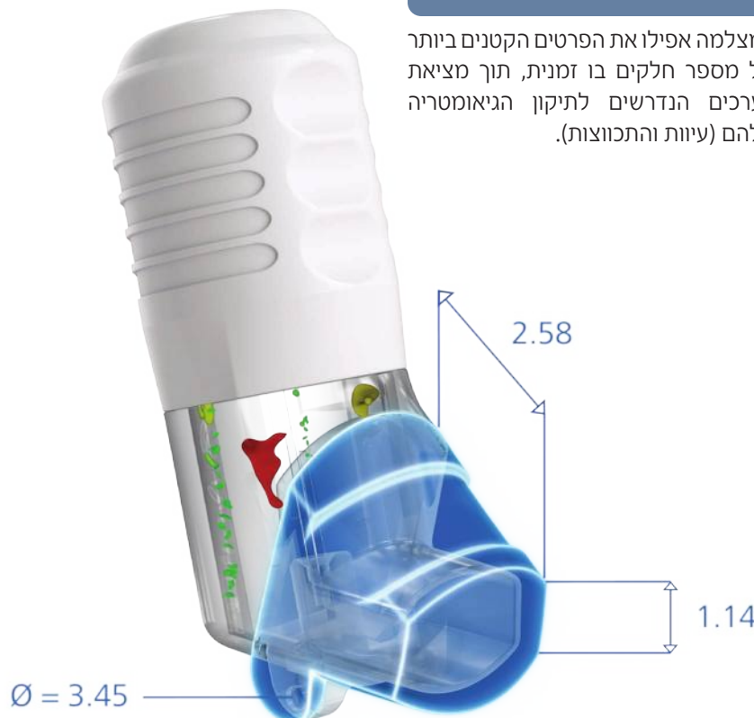
תמונה 1: בקרת איכות של החלק הסופי, משלבת יכולות אנליזה תלת ממדית של CT לאיתור פגמים פנימיים ומטרולוגיה למדידת טולרנסים.
