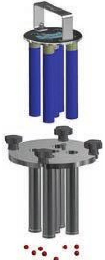
תמונה 1: עקרון כללי של תפקוד המפריד המגנטי MSP-C
