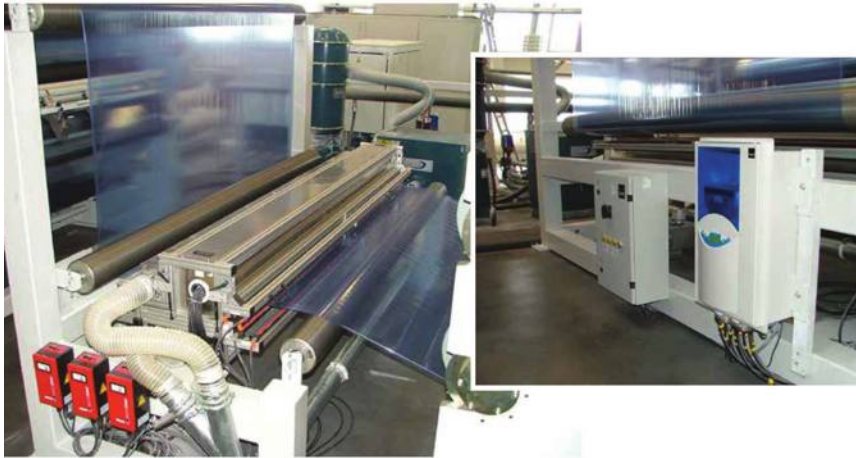
תמונה 2: מערכת איבוק WEKO-ESC משולבת עם AP300 לאיבוק מדויק.
