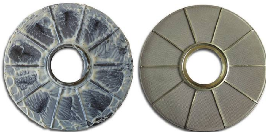
תמונה 3: פילטר לפני ואחרי ניקוי בפירולזה בוואקום.
