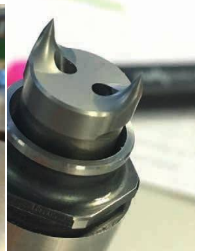
תמונה 1 - מניפולדים של חברת THERMOPLAY. שמאל - תכנון מותאם לקוח להחלפת צבעים מהירה בייצור פקקים בתבנית מרובת מובלעות. ימין - תכנון מותאם לקוח, טיפ בעל שני פתחים להזרקה רכיב איטום בפקק אלכוהולי.
