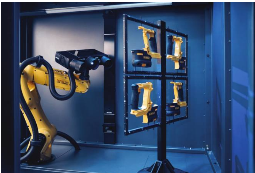
תמונה 2: תא סריקה רובוטי אוטומטי הסורק את החלקים בתלת ממד בעזרת סורק ATOS. סריקה של מספר חלקים בו זמנית.
