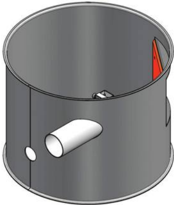
תמונה 2: הגבהה למערכות יניקת הוואקום עם לוחית הגנה מפלדה מחוסמת למניעת שחיקה.
