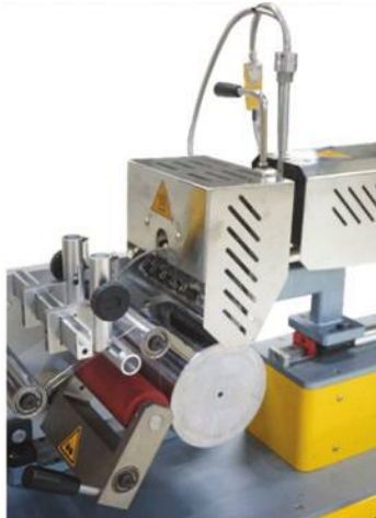
תמונה 2: מיני גליל קירור מסוג LMCR-150 דיזה עליונה צפה מסוג coat hanger.
