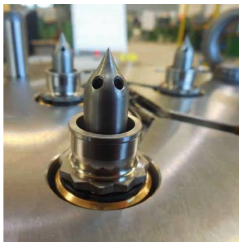
תמונה 1 - מניפולדים של חברת THERMOPLAY. שמאל - תכנון מותאם לקוח להחלפת צבעים מהירה בייצור פקקים בתבנית מרובת מובלעות. ימין - תכנון מותאם לקוח, טיפ בעל שני פתחים להזרקה רכיב איטום בפקק אלכוהולי.
