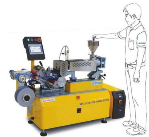
תמונה 1: קו מיני מעבדתי לייצור יריעה חד שכבתית בפיה שטוחה LMCR-150
