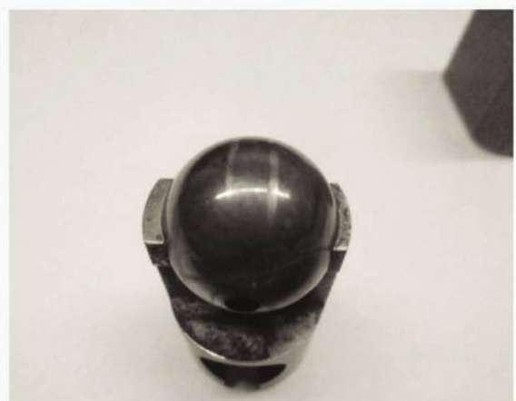
תמונה 3: מפרק המערכת לאחר 2.2 מיליון מחזורי שימוש מראה שחיקה מינימלית.
