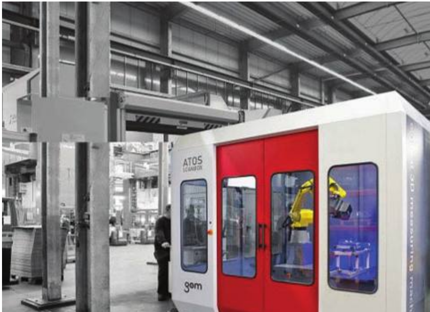
תמונה 1: תא רובוטי לסריקה אופטית, תלת ממדית, של חלקי פלסטיק בקו הייצור.
