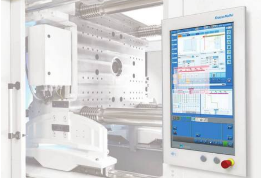
תמונה 2: הדור האחרון של בקרת מכונות הזרקה: יחידת הבקרה MC6 הכוללת smartCube.
