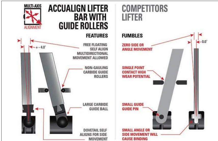
תמונה 2: מוט הרמה מסוג ACCUALIGN מול מוט הרמה סטנדרטי.
