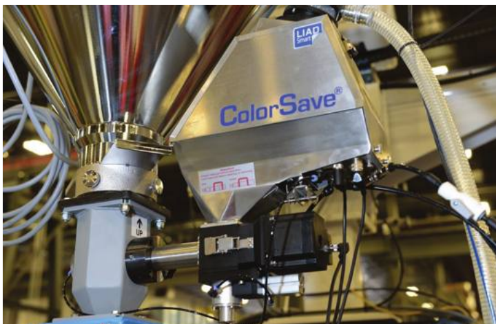
תמונה 2: המזין המשקלי ColorSave 1000 של ליעד מאפשר להזין תוסף צבע ולייצר מגוון רחב של מוצרים בדיוק של 0.1 גרם.
