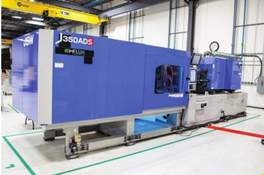
תמונה 1: מכונת JSW- J350ADS, בעלת מערכת בקרה חדשה מבית iMFLUX.
