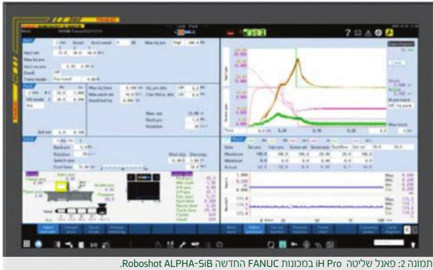
תמונה 2: פאנל שליטה iH Pro במכונות FANUC החדשה Roboshot ALPHA-SiB.
