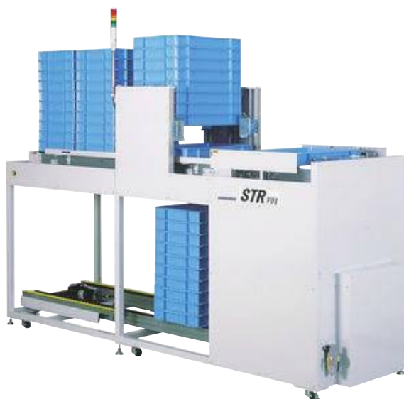
תמונה 2: מערכת STR-V01 - מערכת דו קומתית לניחוב קופסאות מלאות וריקות.
