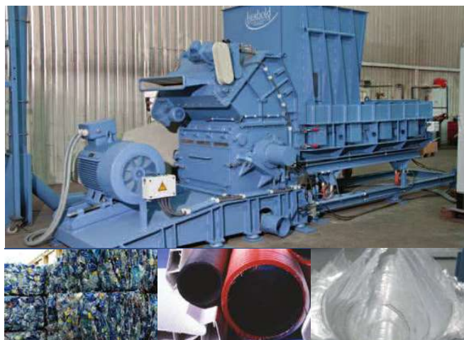
תמונה 1: מגרסה משולבת בשרדר של HERBOLD בחיתוך חד-שלבי. דוגמאות לחומרי הזנה מימין לשמאל: גלילי יריעות, צינורות ופרופילים, מארזים של בקבוקי PET.
