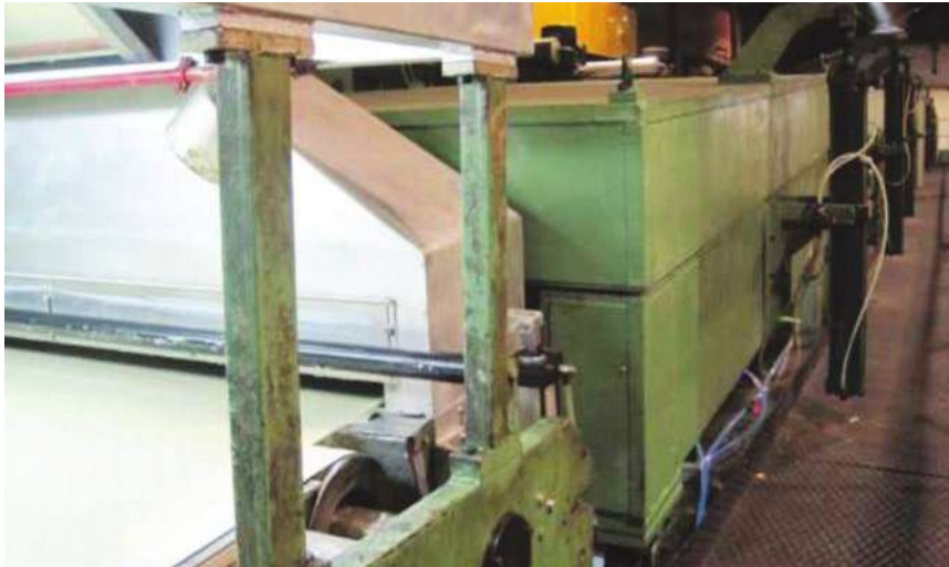
תמונה 2: מתקן ייבוש של HTI (בצבע כסוף) הותקן על מכונה לציפוי נייר לפני כניסת הנייר המצופה למנהרת הייבוש המקורית (בצבע ירוק).
