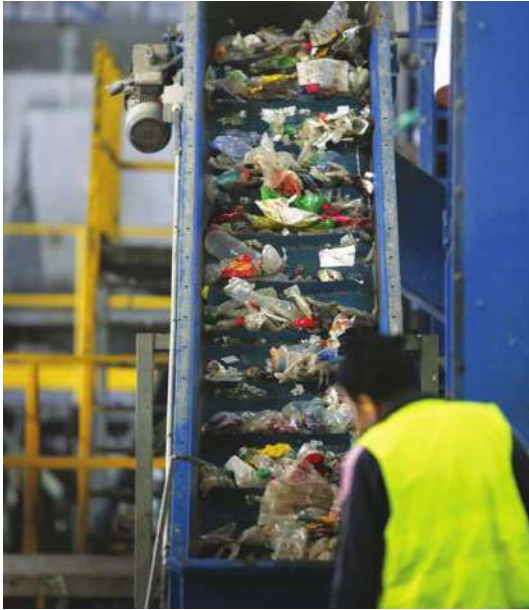
מסוע הזנת חומר הגלם (הפסולת) למערך המיון באביב תעשיות מיחזור.
