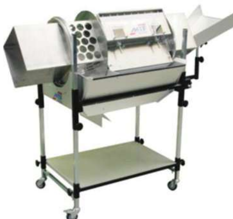
תמונה 2: (מימין לשמאל) תוף הפרדה מלבני, ושילוב של תוף מלבני ומחורר, מבית MTF.
