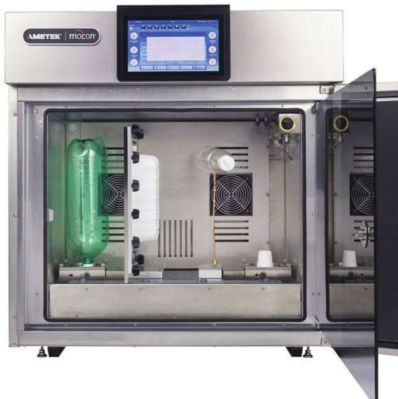
תמונה 3: מכשיר בדיקה עם תא אקלום לביצוע בדיקות בטמפרטורות שונות מטמפרטורת חדר.
