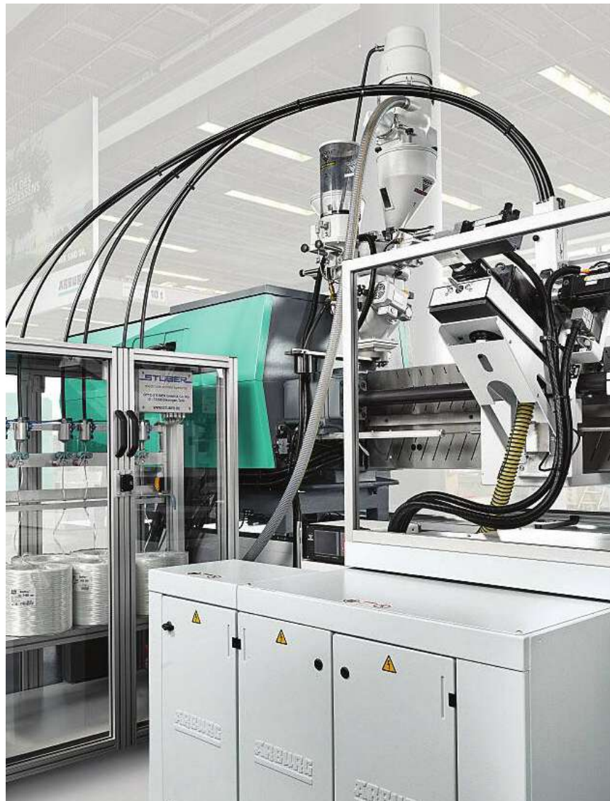
תמונה 1: תא הייצור בטכנולוגיית FDC מבית ARBURG. ייצור חומרים מרוכבים ע"י קציצה ותרכוב של סיבים באורכים שונים כחלק ממטריצה פולימרית על גבי מכונת ההזרקה.
