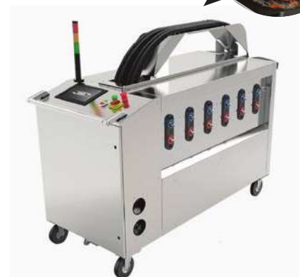
תמונה 1: מערכת CoolingCare של חברת DME. נועדה לפתור בעיה של תעלות קירור סתומות.
