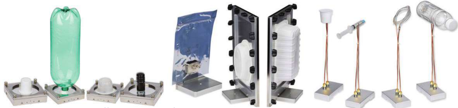
תמונה 2: מחסניות שונות המאפשרות בדיקה של האריזה בצורתה המקורית, ללא צורך בהכנת דוגמה מיוחדת.
