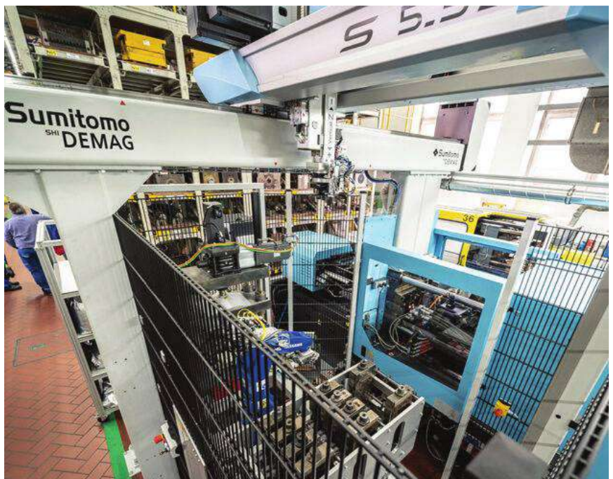
תמונה 1: תא הייצור החדש שפיתחו BASF ו-Sumitomo (SHI) Demag עבור פולימרים לביצועים גבוהים. מדי יום מגדיר צוות המחקר במרכז הפיילוט כ-20 סט-אפים שונות בתא הייצור.
