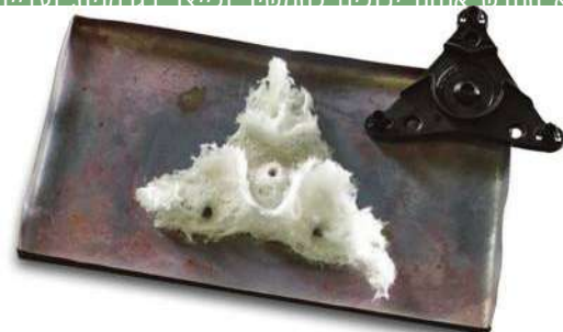
תמונה 2: בדיקות שריפה אישרו פיזור הומוגני של הסיבים, בחלק המיועד לחלון חשמלי לרכב המיוצר עם תא ה-FDC החדש של ARBURG בחברת deller.
