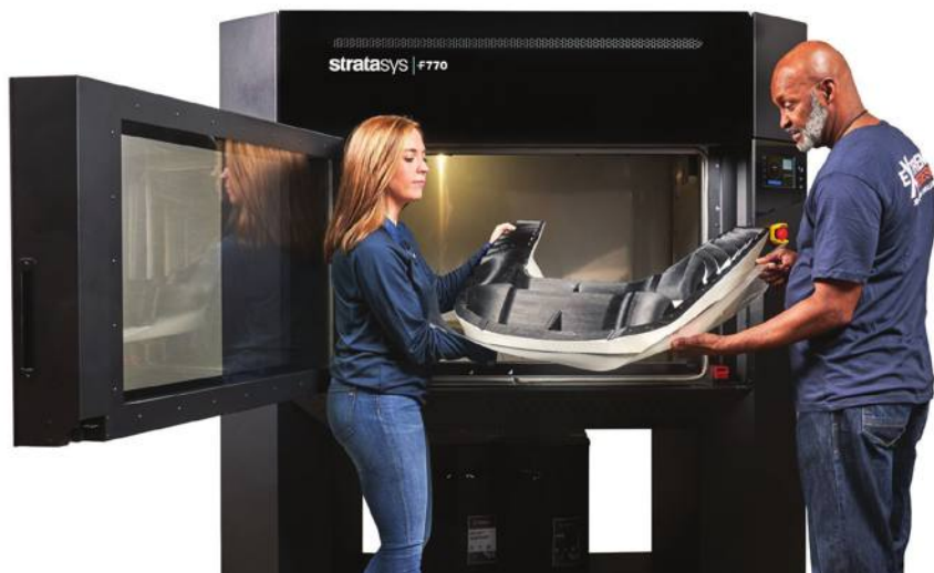
תמונה 3: חלק גדול במיוחד (מיועד לרכבי מירוץ) המיוצר במדפסת ה-F770 של Stratasys.
