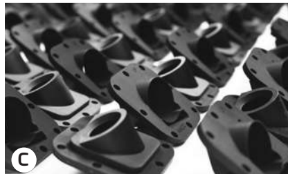
תמונה 4: A - חלק חסין לאש (FR). B - מחבר של חברת TE connectivity הדורש דיוק גבוה. C - מתקן קיבוע למצלמה עם זוויות ייחודיות שקשה לייצר. הכל יוצר באלפי יחידות במדפסת Origin.
