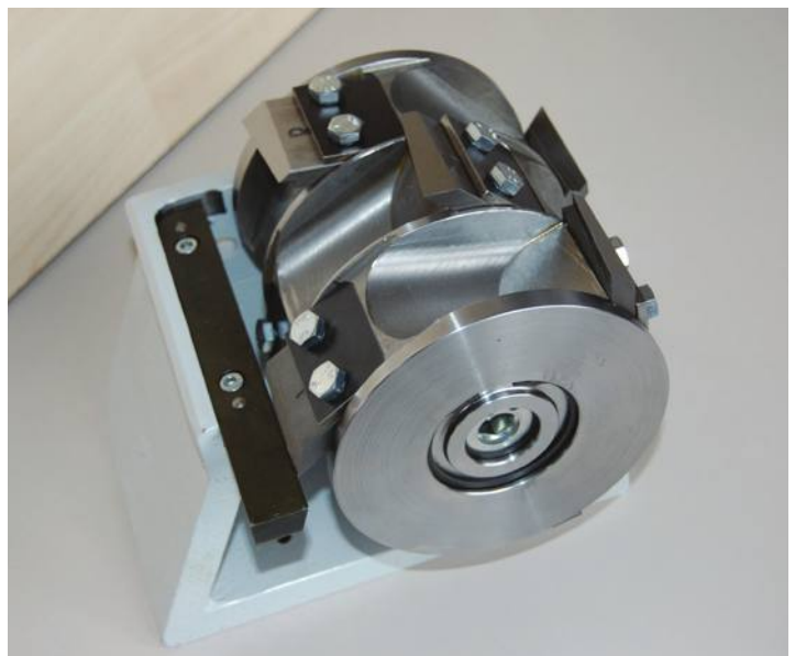
תמונה 1: מנגנון לכוונון מדויק של רוטור הסכינים המתבצע מחוץ לתא, המשולב במגרסות Müller. תמונה 2: גישה נוחה לתא הסכינים באמצעות דלת נפתחת גדולה.
