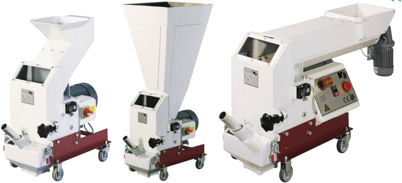
תמונה 3: מגוון הופרים למגרסות Müller: (מימין לשמאל) הזנת Auger, הופר להזנה על ידי רובוט והופר Z סטנדרטי.
