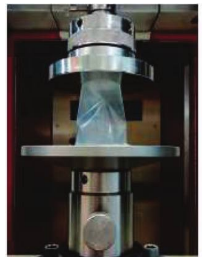
תמונה 1: בדיקת לחיצה לכוסית שיוצרה בתרמופורמינג מיריעה המכילה CON-Batch 30X
