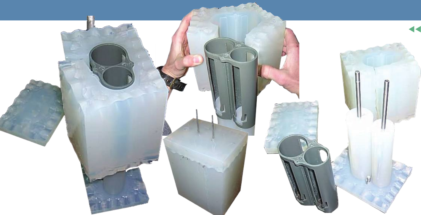
תמונה 2: דוגמה לייצור מוצר (באפור) בתבנית סיליקון גמישה (תבנית לבנה).
