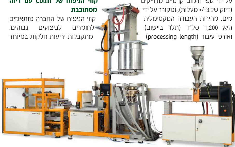
תמונה 3: קו ניפוח לפולימרים לביצועים גבוהים מבית Collin.
