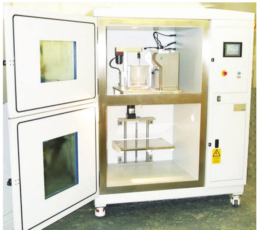
תמונה 1: מכונת היציקה בוואקום מבית MCP-HEK, המאפשרת בניית תבניות עד 70x90x75 מ"מ ובעלת קיבולת יציקת דגמים של עד 5.5 ק"ג.
