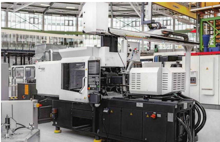
תמונה 2: מכונת ההזרקה הכל-חשמלית IntElect S מבית Sumitomo Demag, הממוקמת במכון המחקר Fraunhofer.
