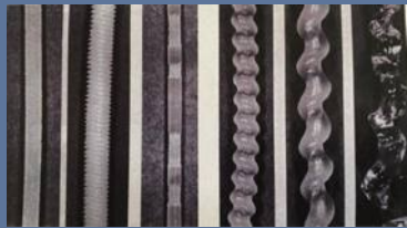
בתמונה: פילמנט שיוצר באקסטרוזיה בעל פני שטח חלקים ומבריקים (משמאל) ועיוותים שונים כתוצאה מהחלקה הולכת וגוברת בדופן הקנה (מימין).
