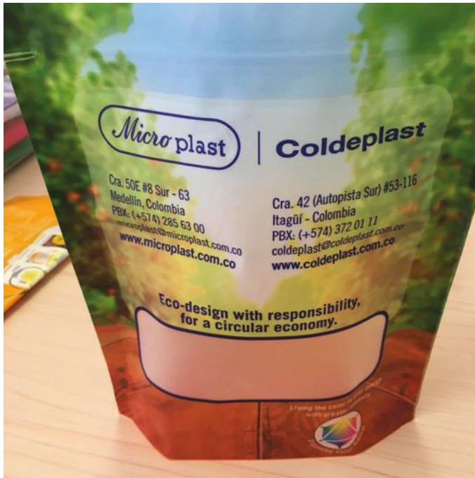
שקית עומדת (Stand up pouch) על טהרת ה-PE. מיוצרת בקו ניפוח 5 שבתי - שתי יריעות מלומנטות אחת לשניה. אפקט המט מתקבל ע"י השימוש בתרכיז המט של תוסף המאפשר בנוסף עמידות תרמית.
