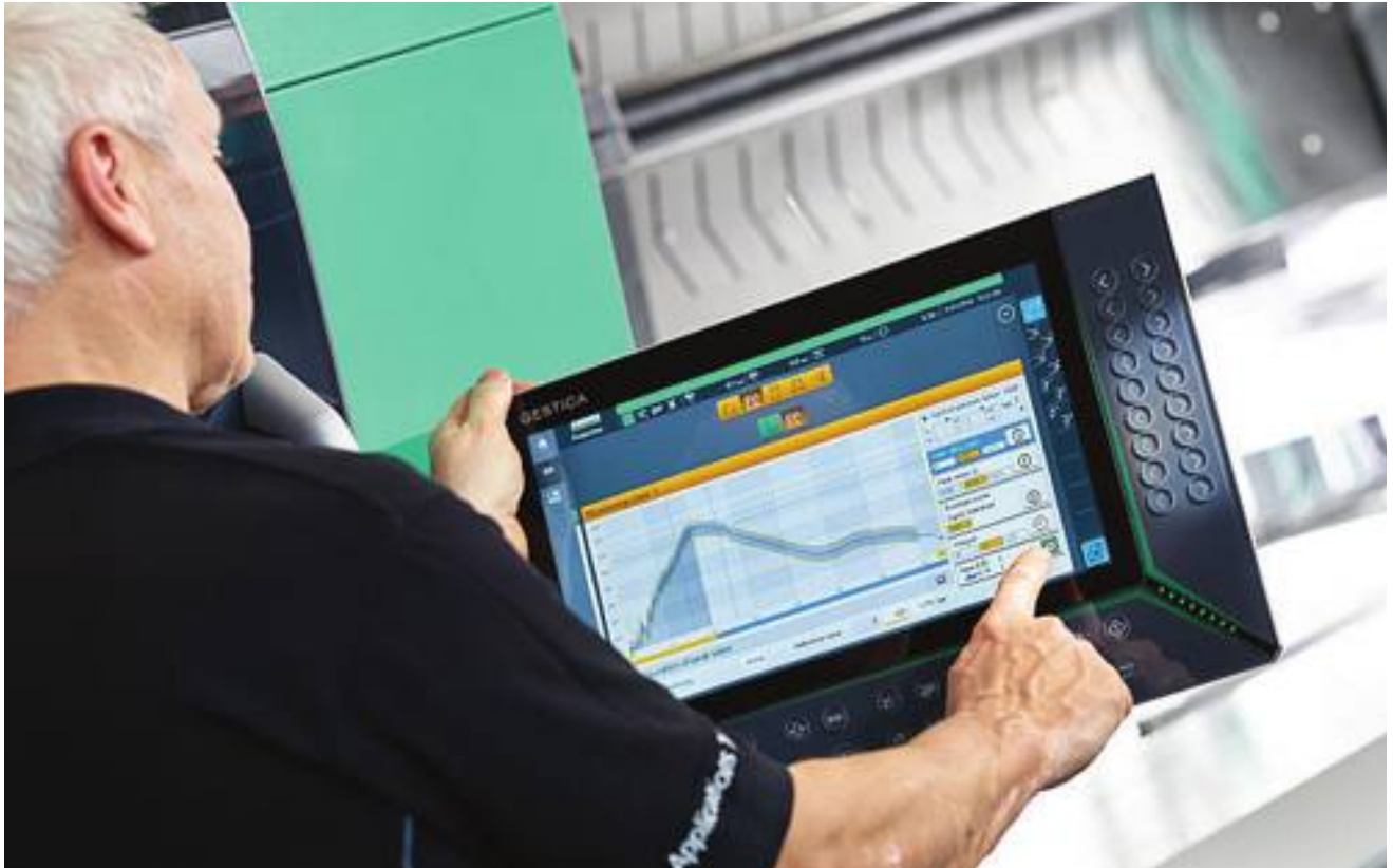
תמונה 3: תמיכה דיגיטלית - חבילת הפיקוח אחרי פרמטרי הייצור. הצגה גרפית של ערכי העבודה אל מול הטולרנסים המוגדרים.
