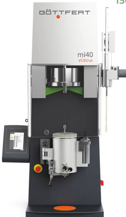
תמונה 1: mi40 Visco - מכשיר חדש מבית GÖTTFERT גם MFI וגם ריאומטר קפילרי.
