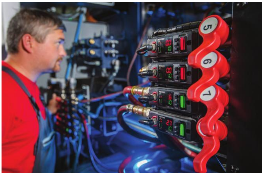
תמונה 1: מערכת בקרת הטמפרטורה אורקה, מפקחת ומווסתת את כל מעגלי הקירור בנפרד ומבטיחה חילופי חום (heat exchange) איכותיים ובקרת תהליכים יציבה.
