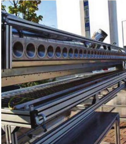
תמונה 2: תמונה של מערכת האיבוק WPA עם חרירים מיקרוניים לאיבוק יעיל.
