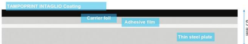
תמונה 2: מבנה גלופת INTAGLIO המספק הדמיה ישירה באמצעות CLICHÉ LASER Xi.
