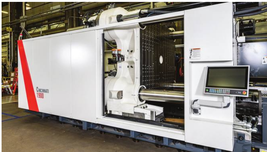
תמונה 2: מכונת סינסינטי 1900 מבית Milacron המכילה מנגנון הגנה לתבנית וחיישנים לניטור מקביליות התנועה.
