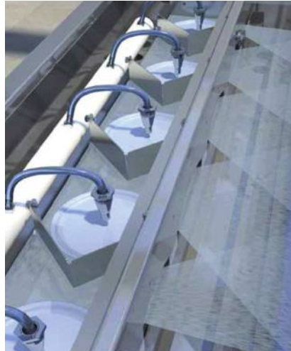
תמונה 1: מערכת WEKO לריסוס תוספים נוזליים.
