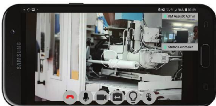
תמונה 2: מכשיר טלפון חכם עם אפליקציית smartAssist המציגה סימונים בזמן אמת על עצמים אמיתיים לאיתור ופתרון התקלה.
