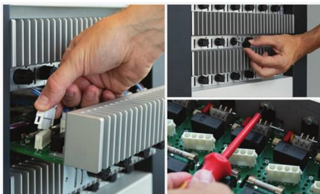
תמונה 3: רכיבים נגישים וניתנים להחלפה בקלות, לתחזוקה נוחה.
