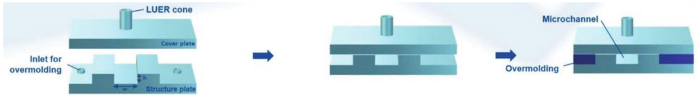
תמונה 3: ייצור צ'יפ מיקרופלואידי בתהליך אחד - שני חלקים שונים המוזרקים באותה התבנית ומחברים ע"י הזרקת Over-molding נוספת.
