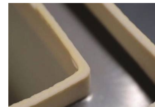
תמונה 3: תבנית המיוצרת בתלת ממד להכנת חלקים מרוכבים. הזרקה של קליפה/מעטפת חיצונית ואיפוקסי פנימי ממנו מיוצרת התבנית. מקור: MASSIVit 3D.
