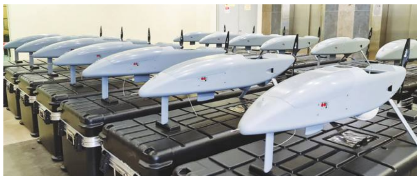
מזל"טים מוכנים אחרי בחינה. כל מזל"ט ממוקם על גבי האריזה שלו והיא משמשת גם שולחן הרכבה.
