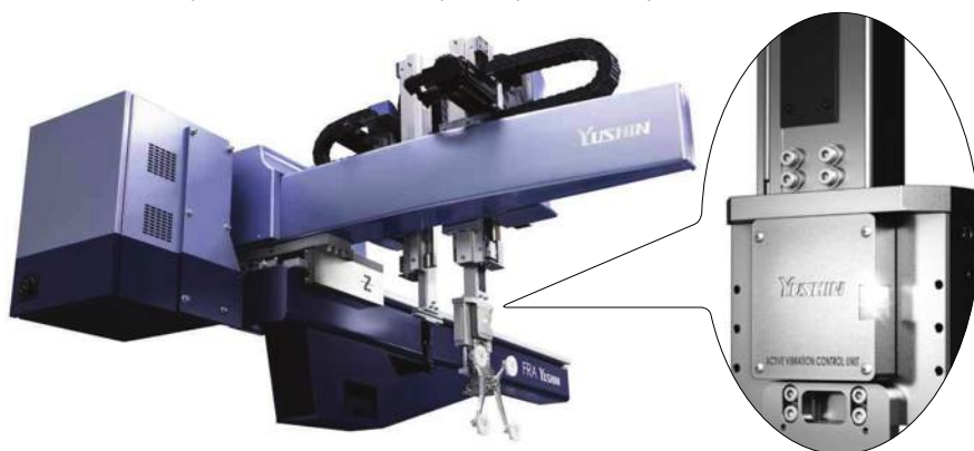
תמונה 1: רובוט FRA-1530D של חברת Yushin בשילוב עם יחידת בקרת התנועה האקטיבית המפצה על ויברציות בתנועה לכיוון הנגדי.
