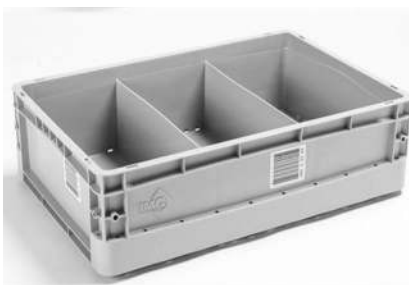
תמונה 3: ארגזי PS בעלי תחתית כפולה בהלחמה אולטרסאונדית, ליכולת נשיאה מוגברת, פלסגד.
