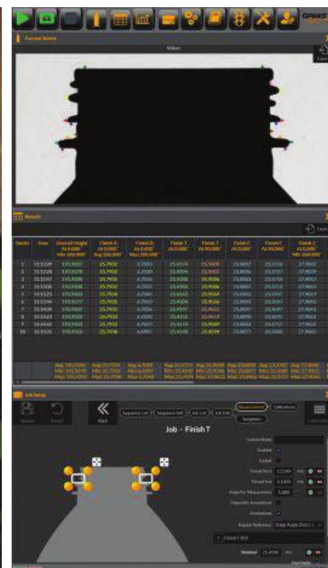
תמונה 1: Gawis 4D של Agr, מערכת חדשית למדידה של מכלי פלסטיק ומבחוץ. תמונה 2: מערכת לזיהוי אוטומטי של נקודות מפתח בבקבוקים ובמבחנות. המפעיל יכול גם להתאים את הבחירה שנעשתה על ידי המערכת.
