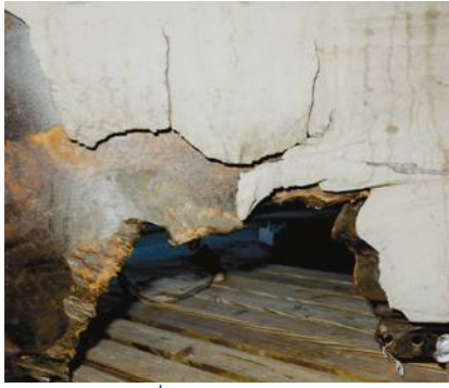
תמונה 5: הקרע שנוצר בגוף טיל ההאצה בעקבות כשל האטמים ודליפת הגזים הלוהטים.
