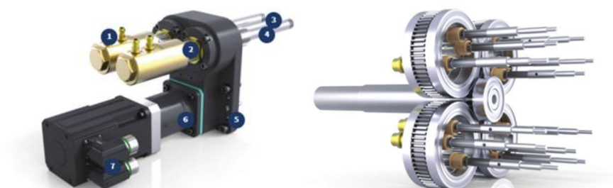
תמונה 6: מנגנון Servo-Mold לשיפור התנועה בתבנית.
