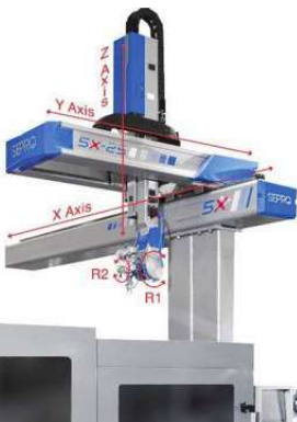
תמונה 1: מערכות הצירים ברובוט SEPRO 5X - חמישה צירי תנועה, כולם בהנעת סרבו.
