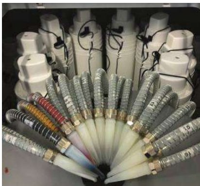
תמונה 2: תירכו הצבע: המערכת מכינה בצורה אוטומטית את הצבע הרצוי מצבעי יסוד נחליים.
