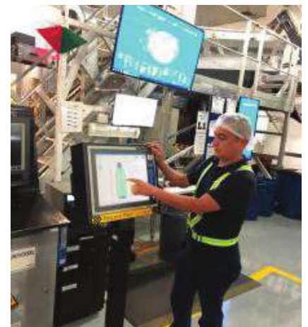
מערכת Process Pilot של Agr לבקרת עובי בתהליך ניתוח ומילוי בקבוקים המוטמעת בקווי הייצור של חברת קוקה קולה במקסיקו.
