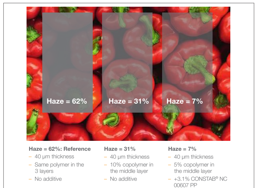
תמונה 1: השוואת עכירות ביריעות פוליפרופילן תלת שכבתיות בעובי של 40 מיקרון.
