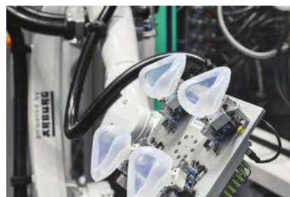
תמונה 2: חליצת מסכת LSR מהתבנית במכונת ARBURG נעשתה בעזרת ציוד אוטומציה מבית Kuka.
