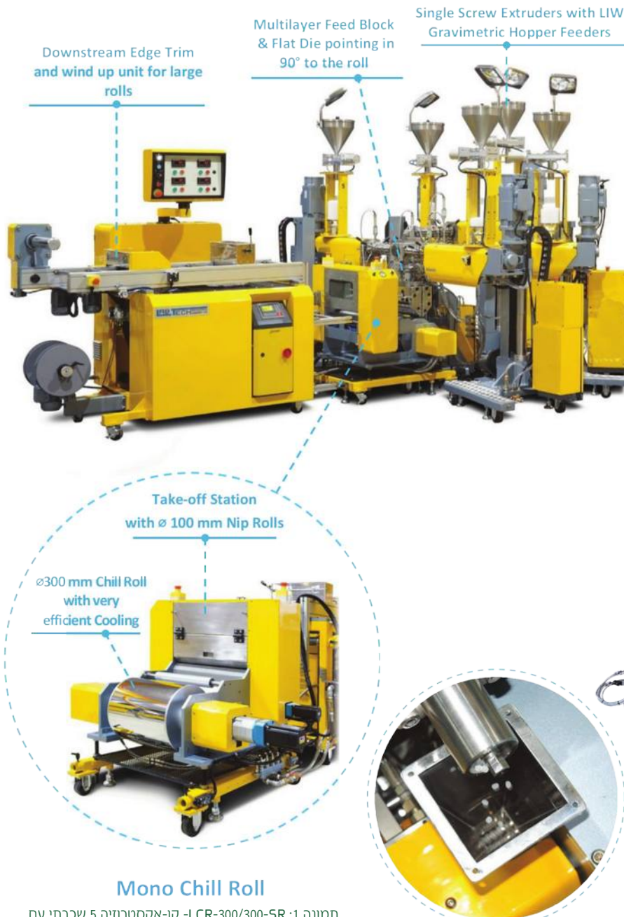
תמונה 1: LCR-300/300-SR - קו-אקסטרוזיה 5 שכבתי עם פיה שטוחה. נמכר לאחרונה ל-Sealed Air בארה"ב.
