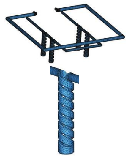
תמונה 3: תעלות קירור בתבנית בעלת ארבע מובלעות. רישות צפוף בקצות תעלות הקירור מבטיח דיוק בתוצאות הסימולציה.
