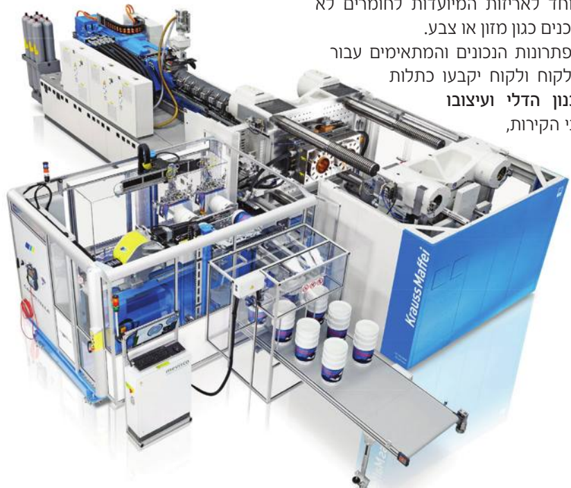
תמונה 1: מכונת הזרקה GX1100 של KraussMaffei עם שתי מובלעות לייצור דליים.
