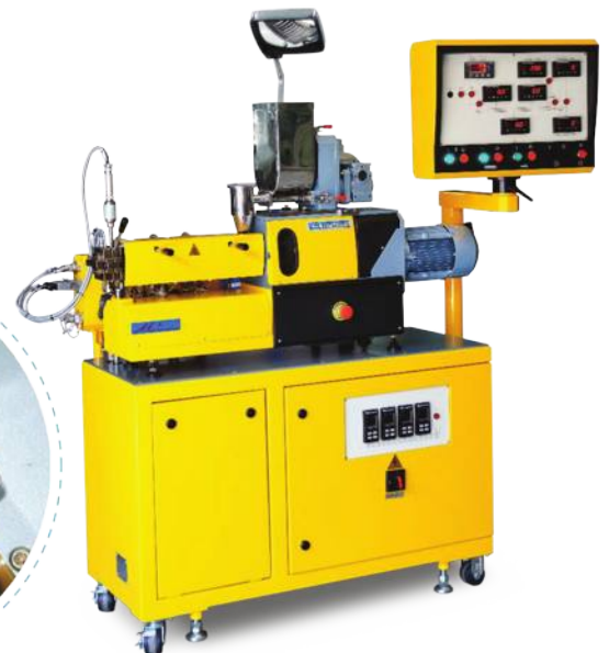
תמונה 2: אקסטרודר דו ברגי 12 מ"מ חדש.
