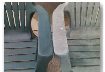
תמונה 2: מוצר חדש (שמאל) לעומת מוצר ישן (ימין) שעמד זמן רב בשמש.
