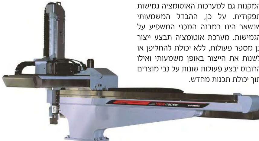
תמונה 2: רובוט שלושה צירים להוצאת מוצרים וסידורם לפי הצורך.
