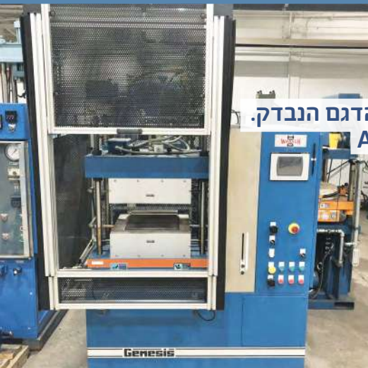
תמונה 1: מכבש הידראולי של חברת Wabash מסדרת Genesis G30H-12. פותח להכנת דגימות לפי תקן D4703.
