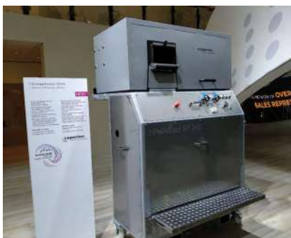
תמונה 2: מגרענת חדשה SP 240, עם כניסת פילמנטים משופרת ונוחות תפעולית.
