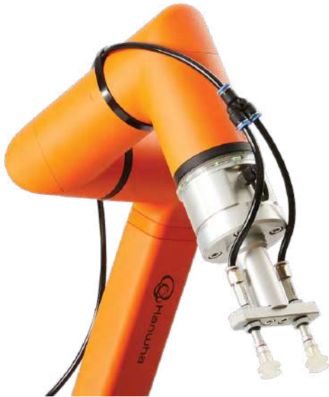
תמונה 1: רובוט שולחני HCR 3. קל משקל וניתן להתקנה במקומות צרים.
