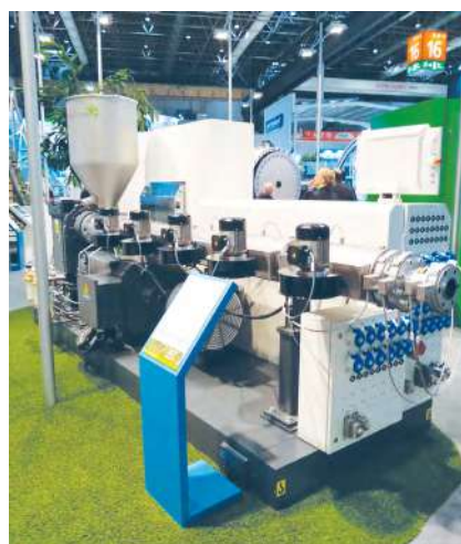
תמונה 2: יחידת עיבוד חדשה שהוטמעה באקסטרודר solEX ומאפשרת הורדת טמפר' עיבוד של 10 מעלות וחיסכון אנרגטי של 15%.
