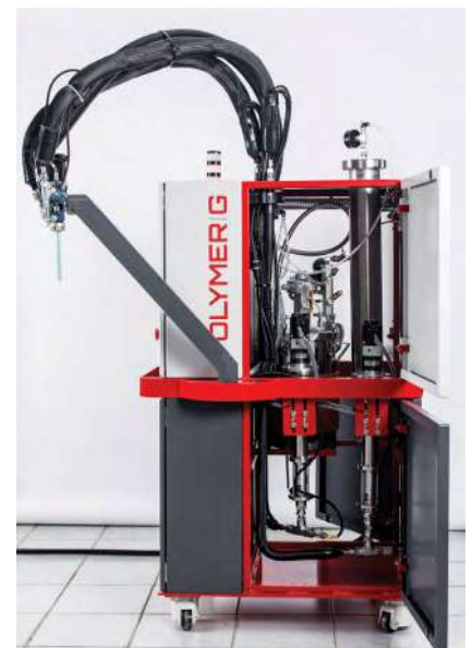
תמונה 1: מכונה לערבוב ומינון אוטומטי של שרפים תרמוסטיים מחברת פולימר גבולות.
