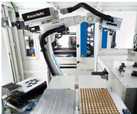
תמונה 2: הדגמה חיה בתערוכת ה-K. ייצור מחברים עם אינסרט מתכתי. דוחות אישיים יוצרו לכל חלק ע"י מערכת ה-easyTrace.
