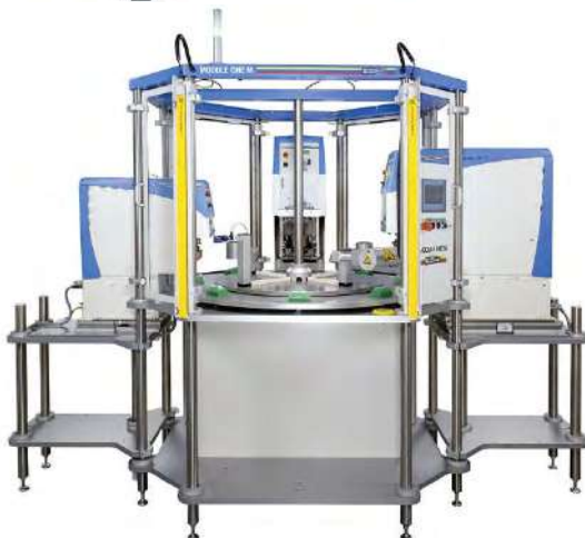
תמונה 2: מערכת MODULE ONE בגודל M מסדרת מכונות ידניות בגדלים שונים לדפוס טמפון.
