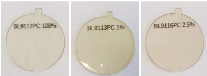
תמונה 7: רמת סינון האור הכחול של שלושה פילטרים אופטיים לאור כחול אשר פותחו בתוסף על בסיס דרישת לקוחות בעלי גוון "סביר".
