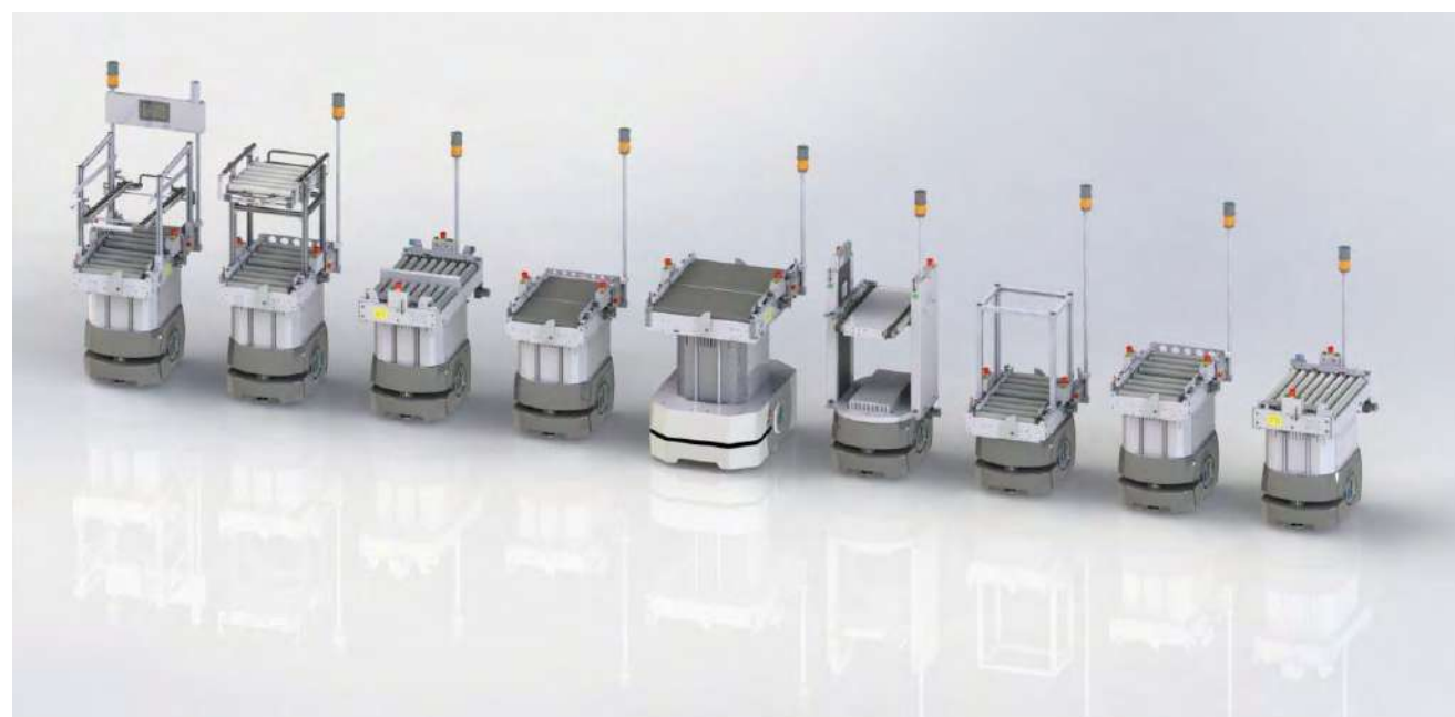
תמונה 4: רובוטים אוטונומיים ניידים לשינוע תוך מפעלי.
