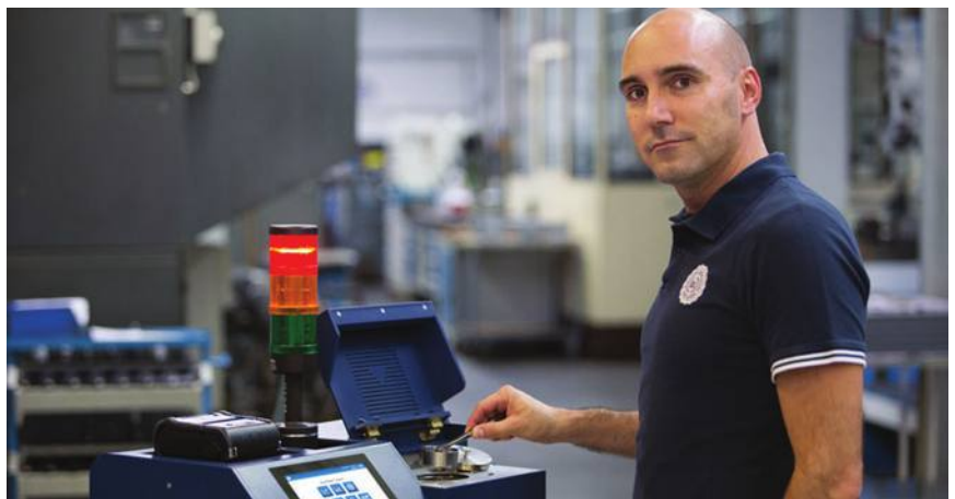
תמונה 2: AQUATRAC® Station - הדור הבא של מדי הלחות. מדידה באווירת וואקום, ללא דסיקנט.
