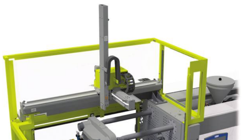
רובוט 5LR מותקן לאורך המכונה, כך שאינו דורש שטח רצפה נוסף על השטח המצומצם של המכונה עצמה.
