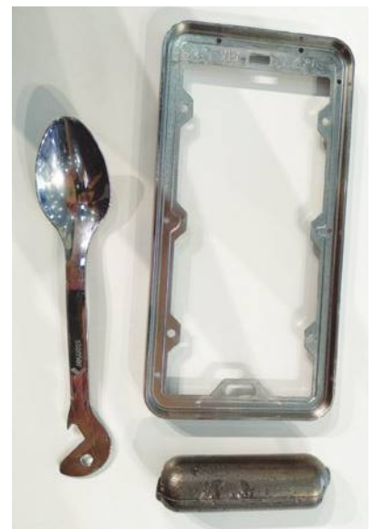
תמונה 1: הזרקת מתכת בגימור מעולה המייתרת תהליכי משנה. מימין, צורת ח"ג בהזנה למכונה.
