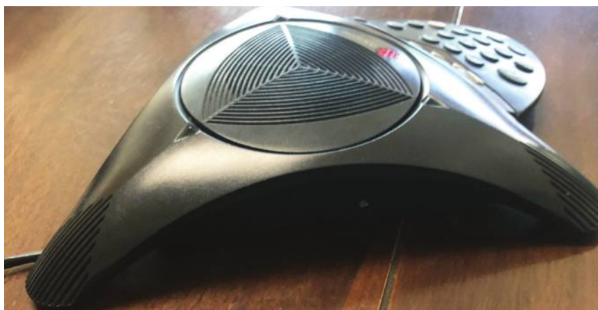
תמונה 3: מוצר מוזרק לתקשורת, עם בידוד אקוסטי המשמש בתכונת שיכוך הוויברציות והרעשים של תרכובת המכיל סיבים אורגניים.
