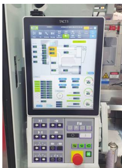
תמונה 3: בקר TACT 5 החדש, מאפשר אינטגרציה לציוד נלווה. במסך העליון: חתך של מחמם תבניות HB-THERM שיוץ
