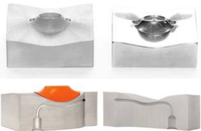
תמונה 3: אינסרט מודפס לתבנית עם תעלות קירור תואמות גיאומטריה מפלדת H13. עלייה של כ-40% בתפוקה
