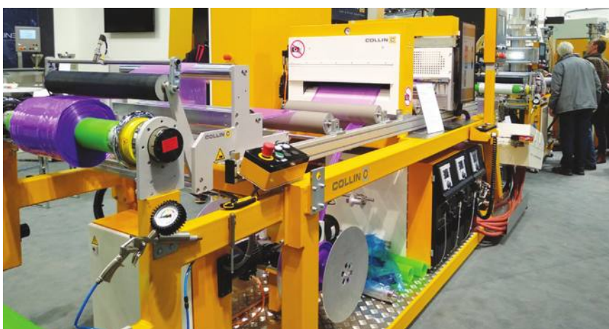
תמונה 1: קו משולב של אקסטרוזיה בניפוח וציפוי ברוחב של 600 מ"מ מבית COLLIN.
