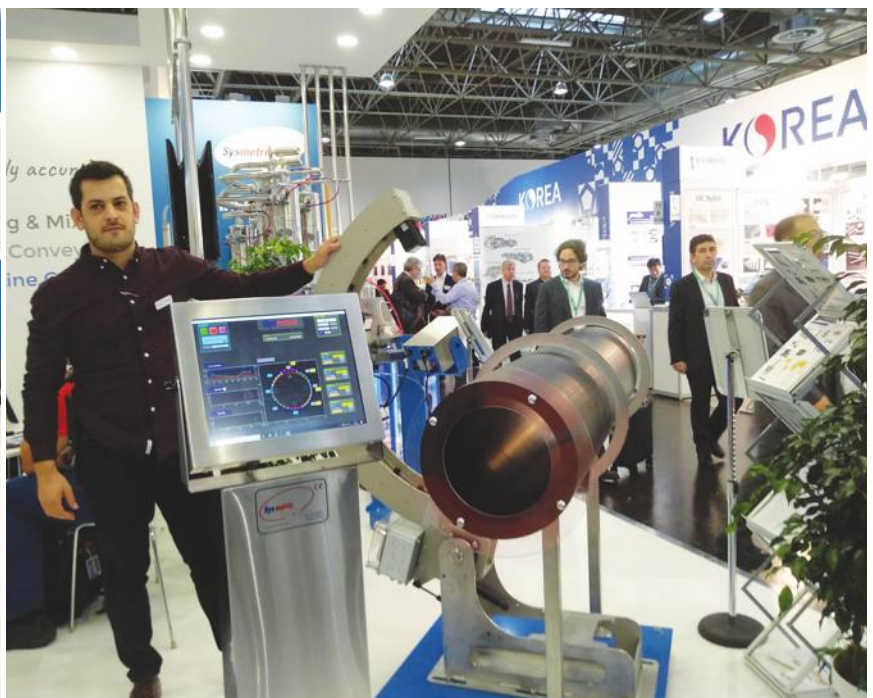
תמונה 1: מערכת SWTG במצב סגור ופתוח, מבוססת גלי רדיו למדידת עובי צנרת בהדגמה חיה ב-2019. א.
