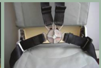
רכיב מושב לצוות מטוס ה-A310 - החלק הראשון שהדפיסה חברת AIRBUS במטוסים, ב-2013. כיום מודפסים AIRBUS עשרות אלפי חלקים מוטסים
