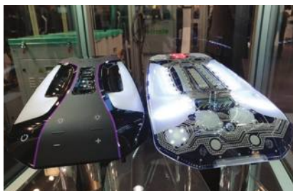
תמונה 2: יישומים מורכבים לתעשיית הרכב. משלבים אלקטרוניקה: לוח PCB גמיש, עליו הותקנו רכיבים חשמליים (נורות LED) שעבר פורמינג ונכנס להזרקה.
