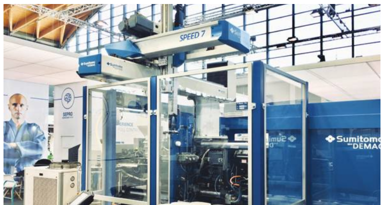
תמונה 2: אחד משני תאי הייצור השלמים שהוצגו בתערוכה. רובוט SDR Speed 7 של SEPRO, הממותג תחת Sumitomo Demag. הרובוט מסוגל להיכנס ולצאת מאזור ההזרקה בפחות משניה אחת.
