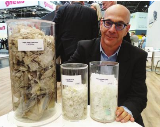
שלוש דוגמאות ליריעות LDPE, משמאל לימין: PCR לפני שטיפה, יריעות לאחר שטיפה קרה, יריעות לאחר שטיפה חמה במערכת ה-Hydrocyclones של HERbold. בתמונה: ירון גוטמרק מחברת מגוטמרק, הנציגים של HERbold בישראל.
