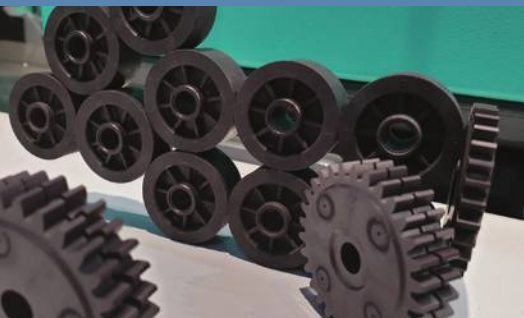
תמונה 3: הזרקה חומר גלם מגנטי העשוי מניילון בתוספת מלאנים מגנטיים (פריטים).
