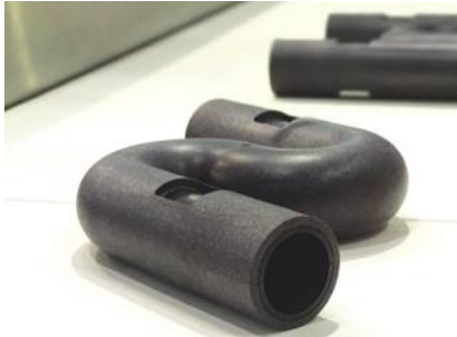
תמונה 3: ייצור במערכת Multi Mold של TOYO. ייצור צינור בצורת 5 בשני חלקים בתבנית אחת ועליהם Over Molding בתבנית אחרת.
