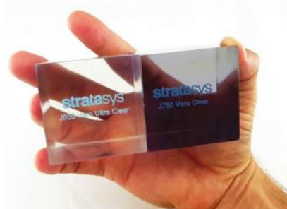
תמונה 2: Vero UltraClear - חומר דו-קומפוננטי המאפשר שקיפות משופרת גם בחלקים עבים.
