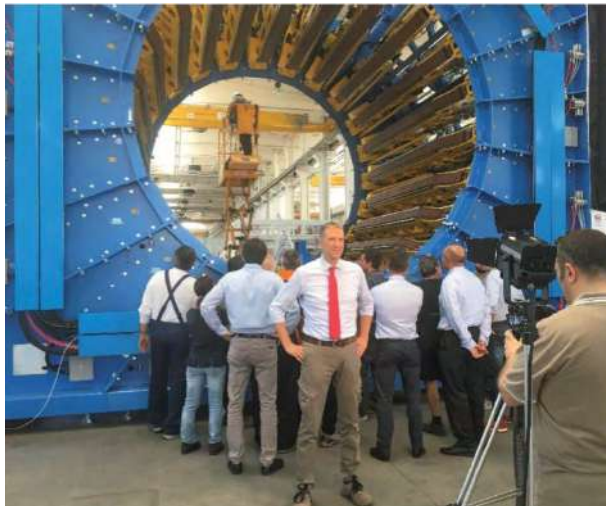
תמונה 1: מושכן הצינורות החדש של SICA עם 24 שרשראות ממונעות, למשיכת צינורות בקוטר של עד 3.5 מטרים.
