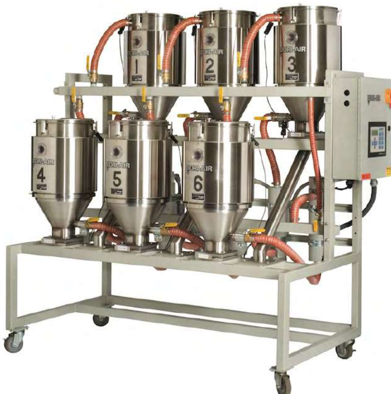
תמונה 2: סוללת מכלי הזנה עם שינוע משולב, לגמישות ייצורית מקסימלית.
