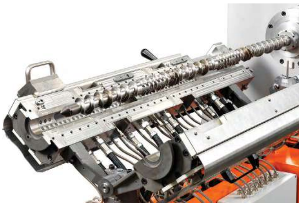
תמונה 2: איזור העיבוד ניתן להתאמה על פי דרישה על ידי הוספה ושינוי מיקום של אלמנטי הלישה.
