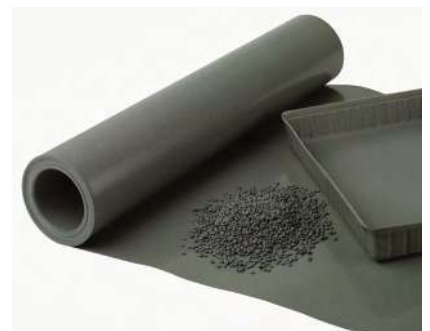
תמונה 2: Ecoallene, חומר פלסטי חדש מפסולת של אריזות Tetrapack® (שילוב של PE ואלומיניום).
