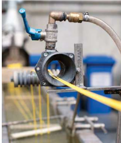
תמונה 2: קו תרכוב מעבדתי לצורך ניסיונות והכנת דוגמאות צבע.
