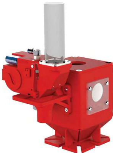
תמונה 4: MCNexus - מינון אופטומטרי בדיוק גבוה, גרגר אחר גרגר, לחלקים מדויקים וקצבי עבודה נמוכים.
