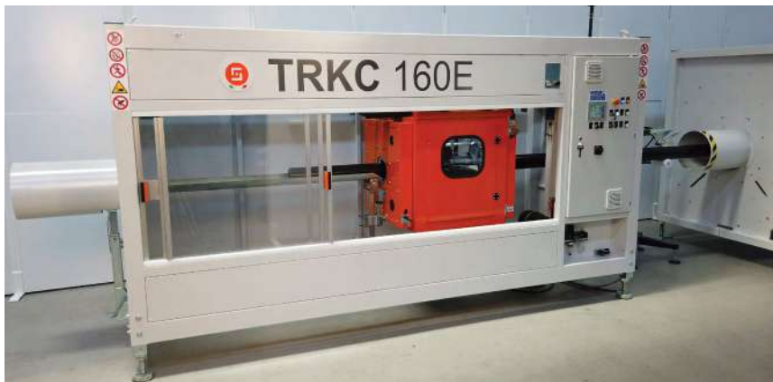
תמונה 2: מסור תעשייתי אלקטרוני TRKC 160E מציג עידן חדש בחיתוך צינורות.
