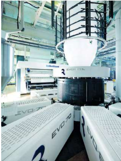
תמונה 1: מערכת Ultra Flat Plus של רייפנהאוזר, מתיחה לאחר ניפ המשיכה - יותר חוזק בפחות עובי.
