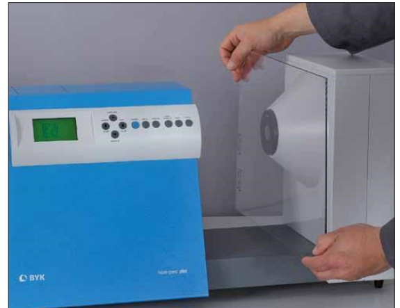
תמונה 1: BYK-Gardner haze meter הוא המכשיר הנפוץ ביותר למדידת תכונות אופטיות של פילמים, לוחות, מוצרי פלסטיק, עדשות וכו'. המכשיר יכול למדוד העברת אור, עכירות ובהירות (clarity). (מקור: BYK Gardner GmbH)
