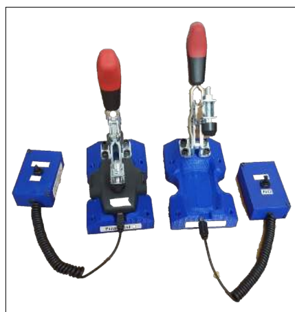
תמונה מספר 8.8: עמדת צריבה בפס ייצור בהדפסה
