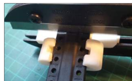
תמונה 7: ספייסר שיוצר בהדפסה, ליצירת חיתוך מדויק יותר.
