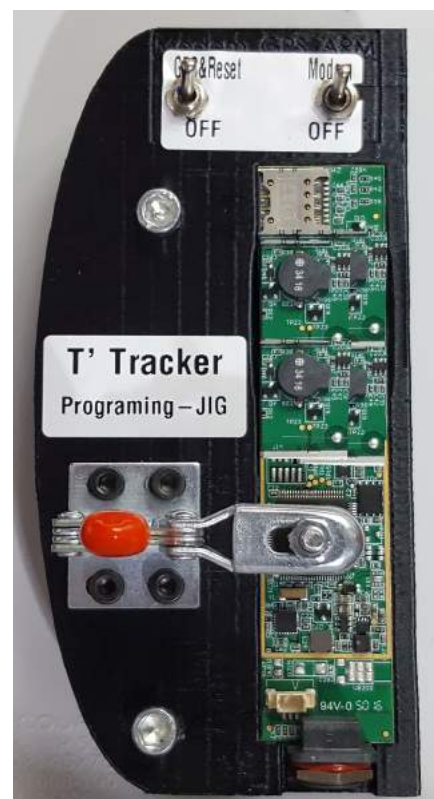
תמונה מספר 8.8: עמדת צריבה בפס ייצור בהדפסה
