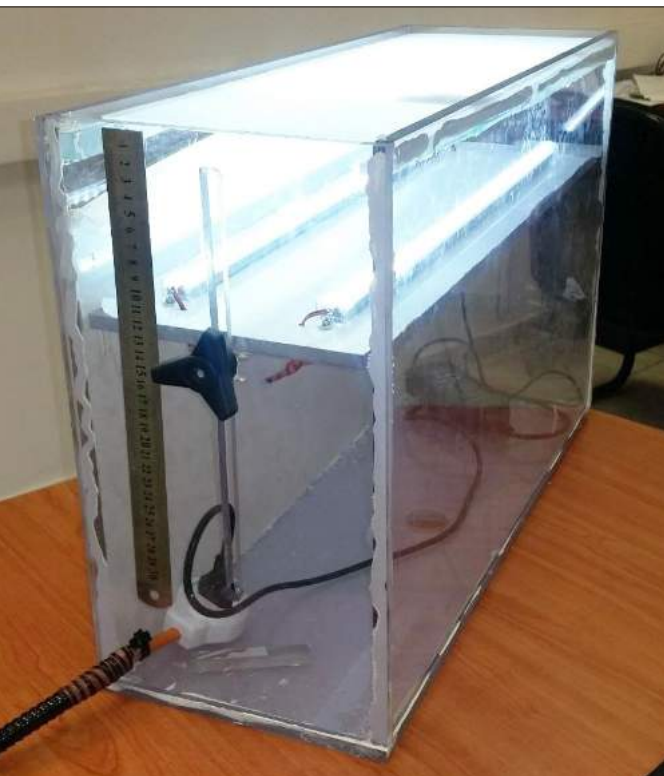
תמונה 3: תא "Hot Spot". הסרגל בצד התא מציין את גובה נורת ה-LED. ככל שהנורות קרובות ללוח הנבדק, כך יותר קשה להשוות. ניתן לבדוק לוחות שונים בזמנית.
