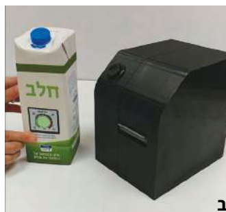
תמונה 4: א - הפעלה ופליטה של החיישן בעזרת דיספנסר ייעודי, מתאים להיקפי ייצור כטנים. ב - הנחת החיישן על גבי המוצר באופן ידני.
