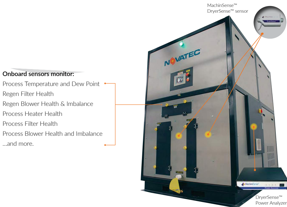
תמונה 1: ייבשן חלת דבש (Novawheel dryer) של חברת Novatec עם חיישני הייבוש DryerSense.
