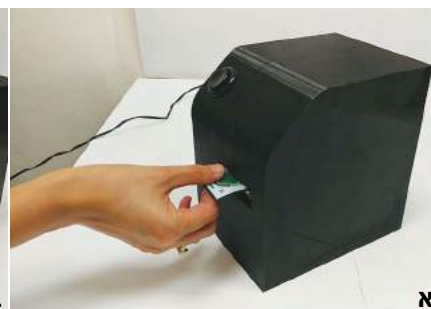
תמונה 4: א - הפעלה ופליטה של החיישן בעזרת דיספנסר ייעודי, מתאים להיקפי ייצור כטנים. ב - הנחת החיישן על גבי המוצר באופן ידני.
