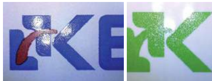
גלופת לייזר לפיזור צבע אחיד גלופת צריבה כימית פיזור צבע משתנה
