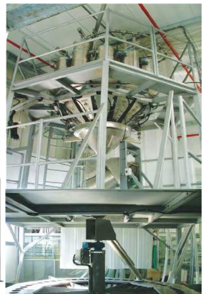
תמונה 1: מערכת ערבול מנות מרכזית PelletSave, לשקילה סדרתית של חומרים.
