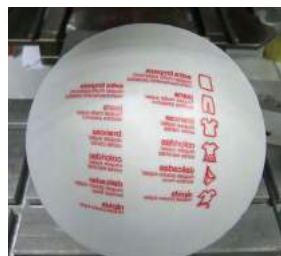
תמונה 6: הדפסת פאנל של 120X100 בתהליך בודד, במכונת TURBO 165 עם הדפסת טמפון גדולה בכוס ירוקה של 165 מ"מ. התוצאה נקייה מחורי סיכה.
