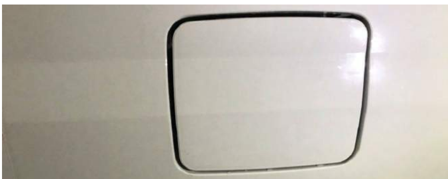
תמונה 5: דלת תא התדלוק, עשויה פלסטיק ומתאימה לצביעה באותו תהליך כמו כל שלדת הרכב החיצונית.
