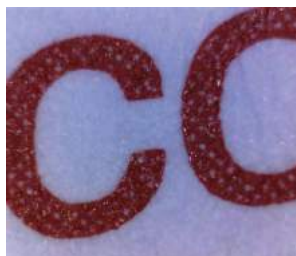
תמונה 6: הדפסת פאנל של 120X100 בתהליך בודד, במכונת TURBO 165 עם הדפסת טמפון גדולה בכוס ירוקה של 165 מ"מ. התוצאה נקייה מחורי סיכה.
