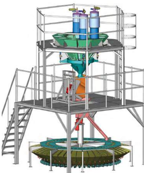
תמונה 1: מערכת ערבול מנות מרכזית PelletSave, לשקילה סדרתית של חומרים.
