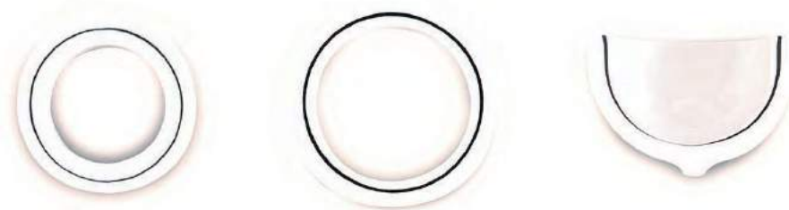
תמונה 3: מיקום שכבות החסמות. צד ימין, שכבת חסמות בכיפת המבחנה - מאפשרת חסמות רציפה. צד שמאל: השכבה החוסמת ממוקמת במקום האופטימלי, רחוק מפני השטח החיצוניים וקרוב יותר לליבת האריזה.
