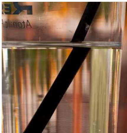
תמונה 3: שבירת האור בעת מעברו בתוך מים. ההבדלים במקדמי שבירת האור השונים בין אוויר ומים גורמים לאשליה אופטית כאילו הקש "מקופל".
