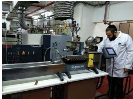
תמונה 5: 3 קווי קומפאונדרים דו-בורגיים בתפוקות משתנות: ממאות גרמים ועד למאות קילוגרמים לניסיונות תעשייתיים
