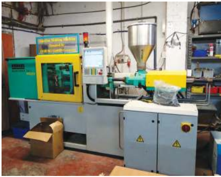
תמונה 6: מכונת הזרקה לצורך הכנת דגמים לחקר ולבדיקות שונות, כמו גם ולהזרקות ניסיון של לקוחות
