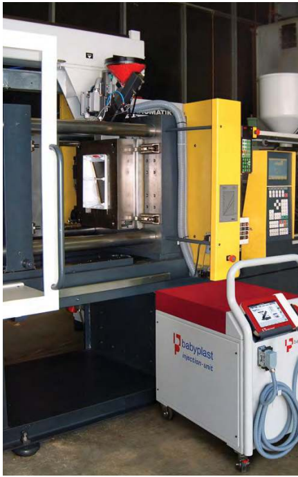
תמונה 4: UAI I/10P - 25P, יחידה אוטונומית המשמשת כ"תוספת" להזרקת רב חומרים.
