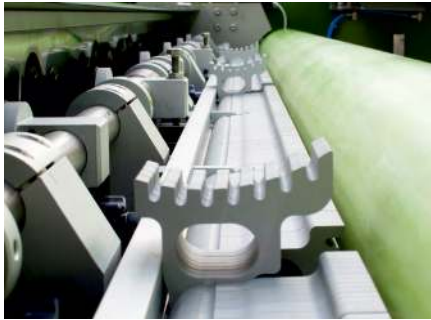
תמונה 2: אלמנטים מאלומיניום בעובי של 5/10/20 מ"מ ניתנים לכיוון עצמאי ומאפשרים לקבוע אילו אזורים ביריעה לא יטופלו.
