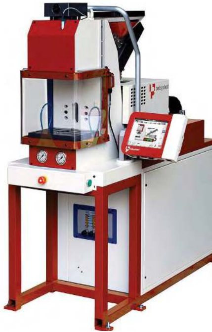
תמונה 3: Babyplast 6/10PV, מכונה אנכית המיועדת להזרקת חלקים Insert Molding - בעלי דיוק גבוה.
