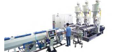
תמונה 1: קו אקסטרוזיה לצינורות PP משוריינים של JWELL
