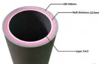
תמונה 2: שטח חתך של צינור רב-שכבתי המכיל שכבת PP משוריינת עם סיבי זכוכית.
