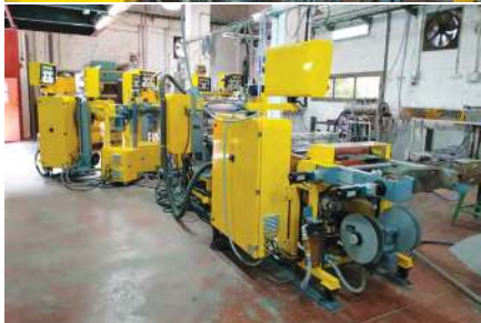
תמונה 3: קו-אקסטרוזר CAST עם טכנולוגיה של הכפלת שכבות לאלפי שכבות ננומטריות ביריעה
