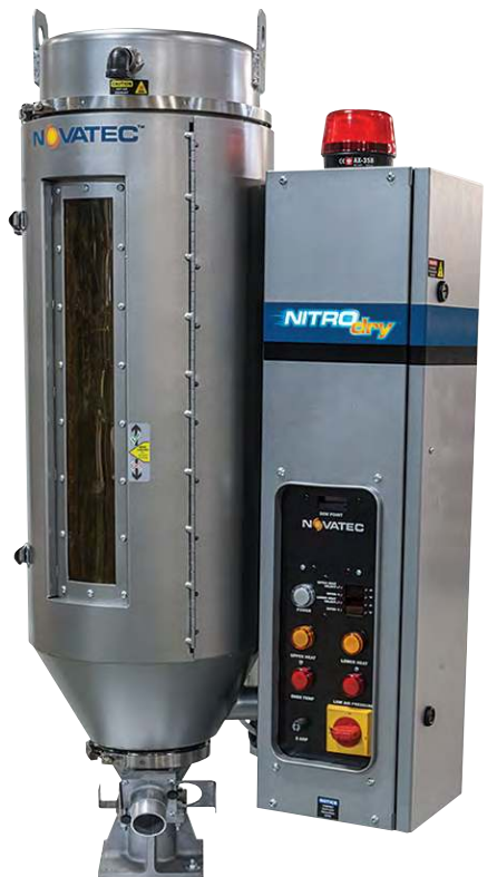
תמונה 4: יבשן NDN המאפשר ייבוש בטיחותי באוויר חנקן אותו הוא מפיק מהאוויר בחדר ללא צורך בבלוני חנקן ייעודיים.
