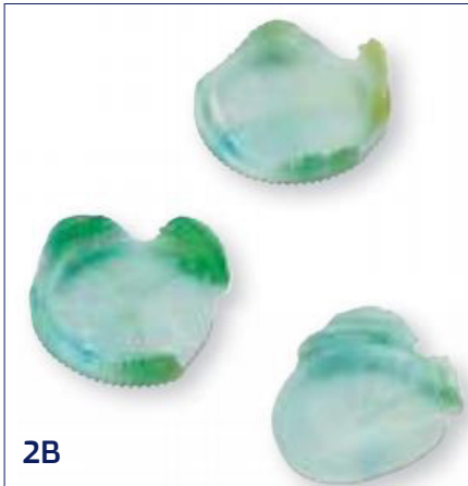
תמונה 2: שימוש בחומר הניקוי הנכון מונע תופעות של פלאשים, 2A או של מנות חסרות, 2B
