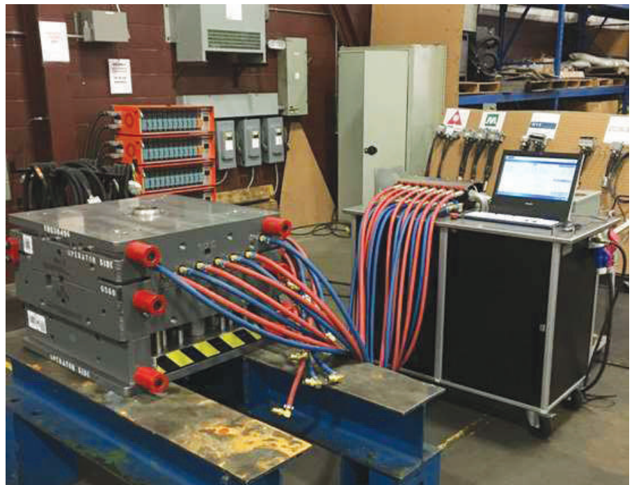
תמונה 1: מתקן הבדיקה של חברת Mouldflo לבדיקת יעילות קירור התבנית. מלבד הבדיקה המידע על התבנית נאגר ומאפשר לעקוב אחר תוצאותיה לאורך כל עבודתה.
