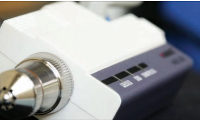
תמונה 3: מיינן אוויר ב-ColorSave-Micro לפתרון בעיות הנגרמות כתוצאה מחשמל סטטי.
