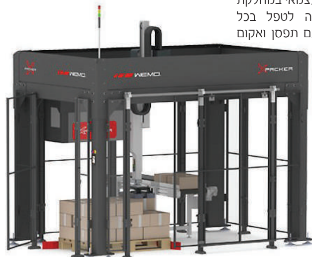
תמונה 2: יחידה שלמה המכילה רובוט, מסוע ויחידת בטיחות לאריזת מוצרים לאחר ההזרקה.
