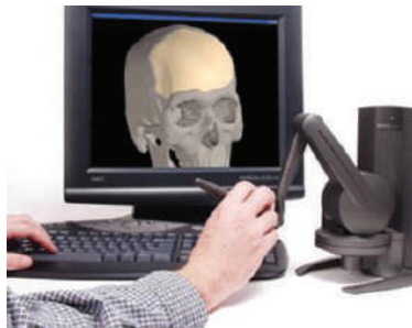
תמונה 1: תכנון ממוחשב בעזרת תוכנת ה-Freeform לשלל תמונה 2: מכשיר ה-Haptic המאפשר לפרוצדורת cranio ניורוכירורגית. סימולציה תחושתית לפני השטח של החלק המודפס.
